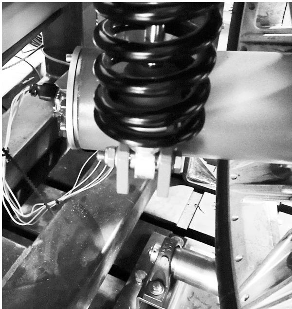
Bild 4-14: Anbau des Gyrosensors an der Rückseite der Radachse
