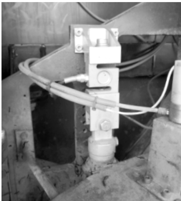
Bild 2-2: Einbau der Vertikalkraftmessdose bei dem SKM-Messfahrzeug mit SCRIM-Messmechanik der IWS Messtechnik GmbH
