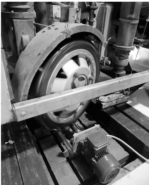
Bild 4-30: Messfahrzeug mit britischer SCRIM-Messmechanik auf dem Walzenprüfstand
