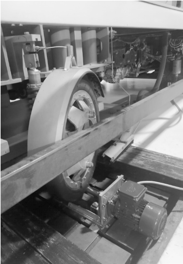
Bild 4-27: Messfahrzeug mit SKM-Messmechanik auf dem Walzenprüfstand
