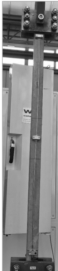
Bild 5 - 62: Aufgeklebte Tauchanker auf zyklischen Dehnkörper
