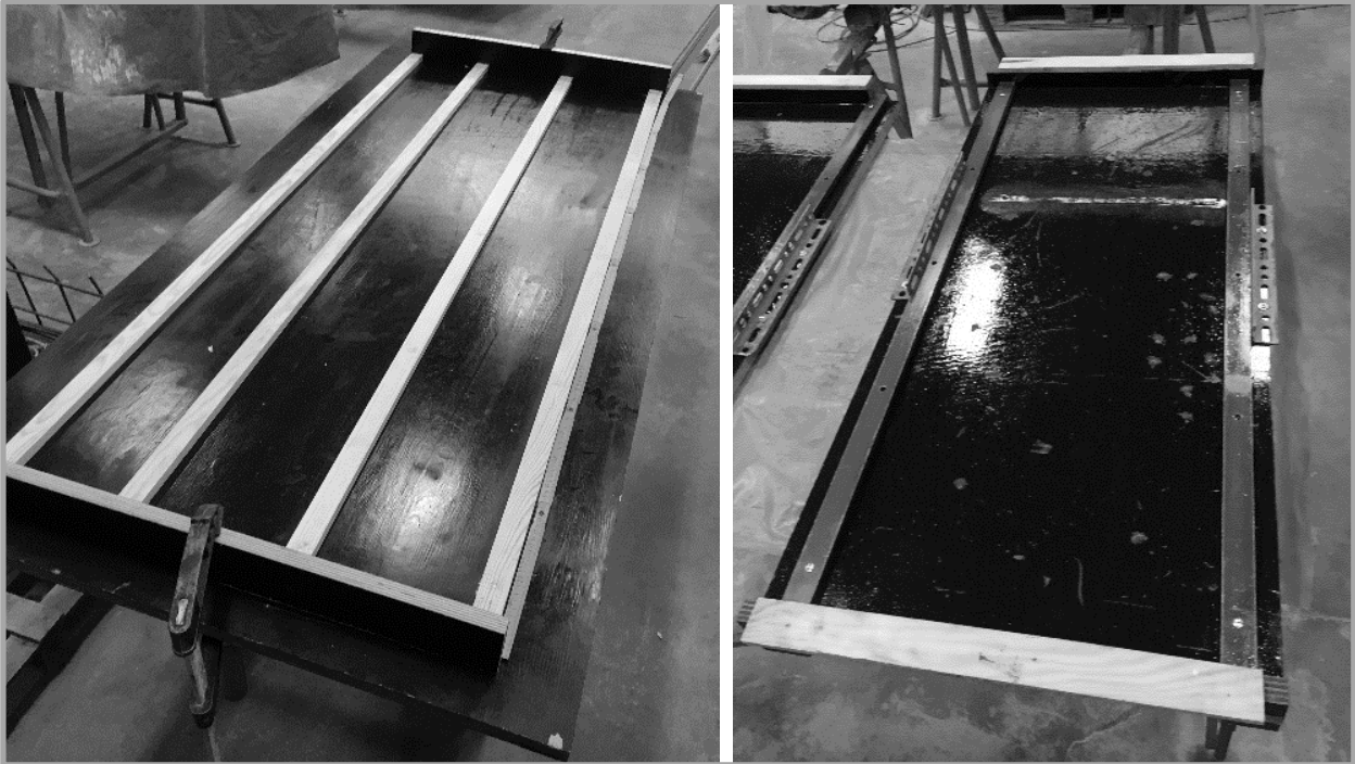
Bild 5 - 51: Schalungsform für zyklische und statische Prüfkörper.
