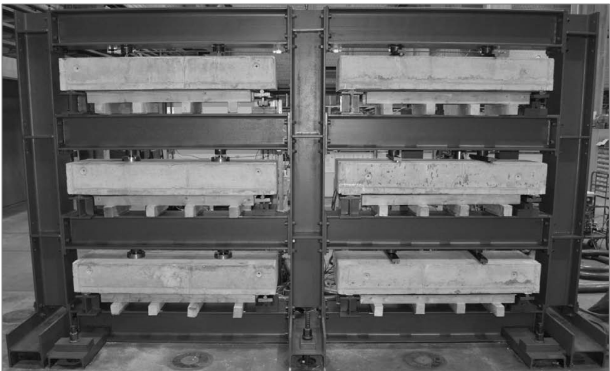
Bild 5 - 41: Mehrfachprüfstand für die zyklische Beanspruchung (BREITENBÜCHER & NEUMANN (2018)).
