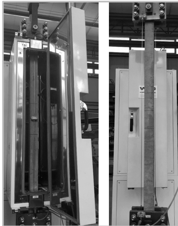
Bild 5 - 63: Links - Probekörper im Heizschrank, rechts - Probekörper mit Tauchankern auf der Klemmung.
