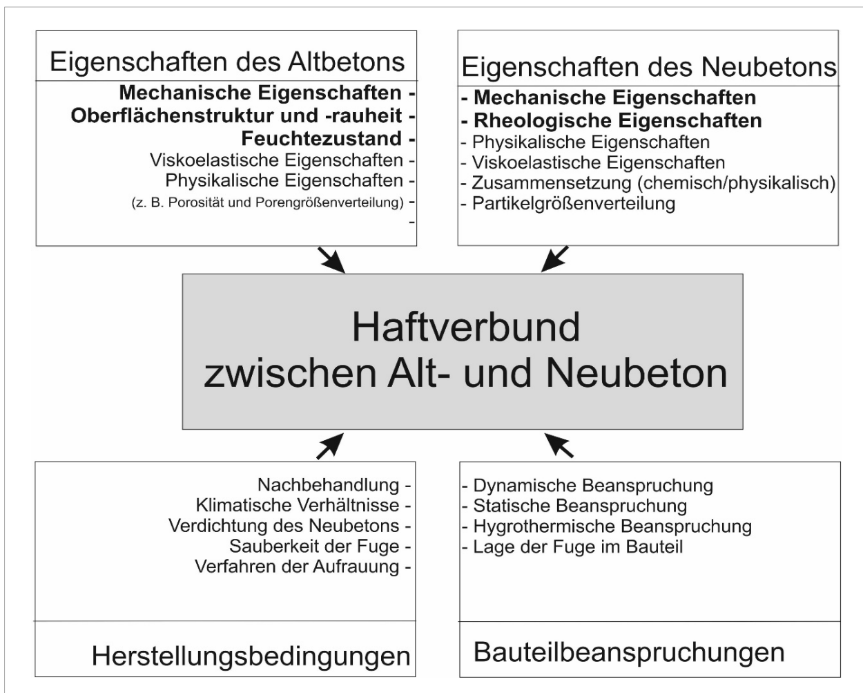
Bild 3 - 15: Schematische Darstellung wichtiger Einflussgrößen für den Haftverbund (MÜLLER 2009).
