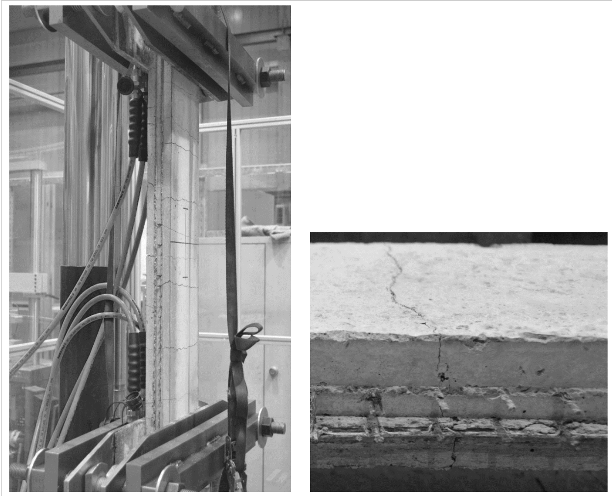
Bild 5 - 6: Links - Rissbild während des Versuchs, PK1_A, rechts - Typischer Rissverlauf in den Zugprobekörpern.
