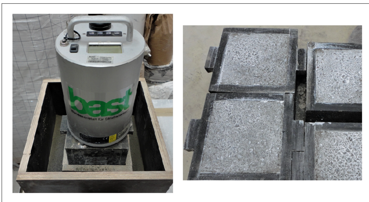
Bild 4-9: Messungen der Ausbürsttiefe mit dem ELAtextur-Messgerät (links); nachbehandelte Waschbetonoberflächen der Würfelprobekörper (rechts)
