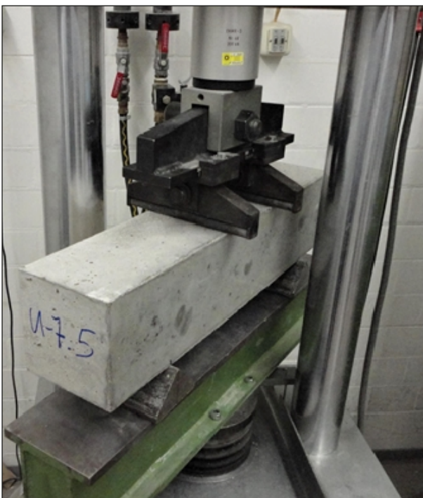
Bild 5-2: 300 kN-Druck-Biegeprüfmaschine Typ DB-300-S umgerüstet für den Biegezugversuch
