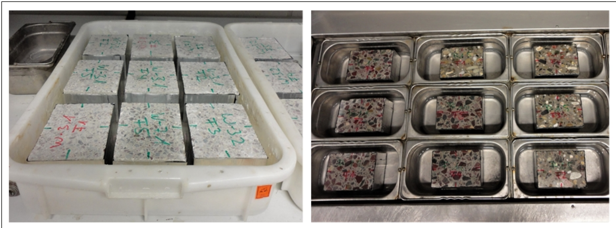
Bild 5-3: CDF-Prüfung: Vorsättigung der Prüfkörper (links); zur Frost-Tausalz-Belastung in die Truhe eingelagerte Proben (rechts)
