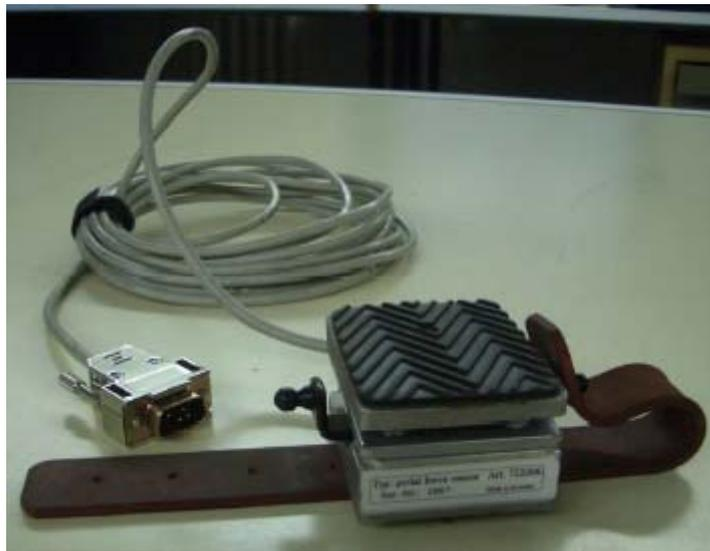
Abbildung 15.6: Pedalkraftsensor Typ 1007
