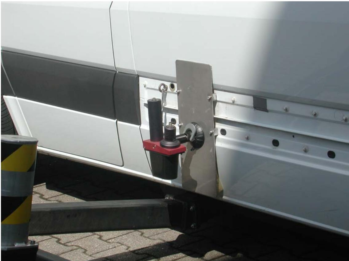
Abbildung 15.9: Montage des V1-Sensors der Firma Corrsys-Datron am Sprinter
