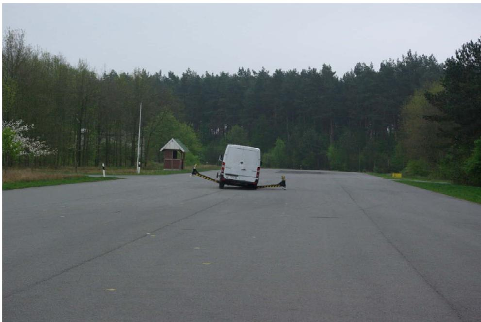
Abbildung 16.42: Sinuslenken (ISO 7401) auf der Teststrecke in Nordhorn
