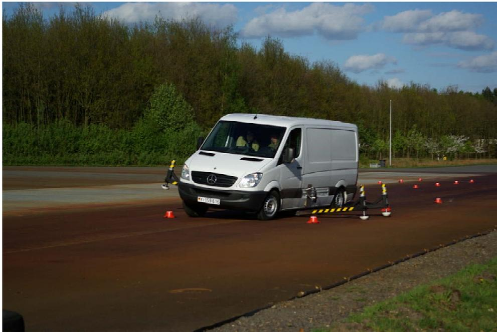
Abbildung 16.24: VDA Gasse (ISO 3888-2) auf der Teststrecke in Nordhorn
