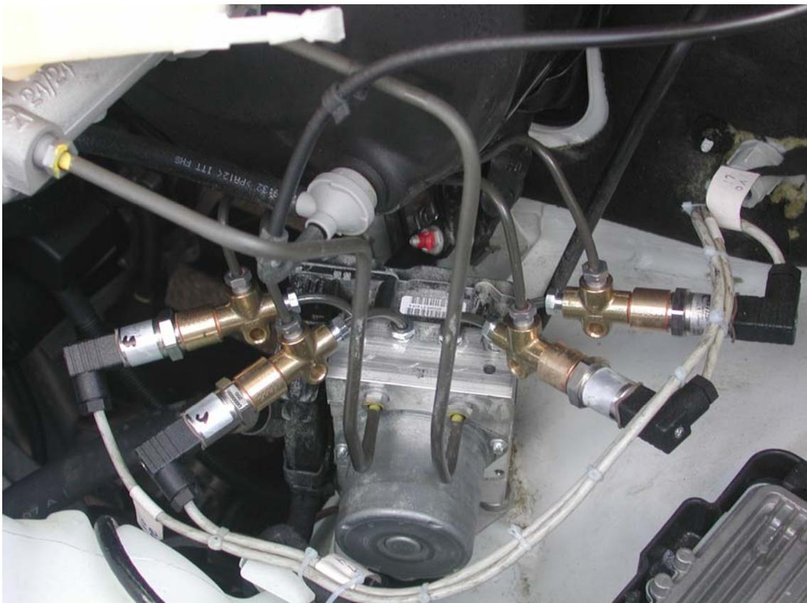
Abbildung 15.10: Anschluss der Bremsdrucksensoren des Sprinter
