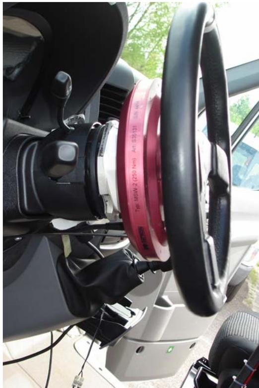
Abbildung 15.3: Messlenkrad Montage des Sprinter
