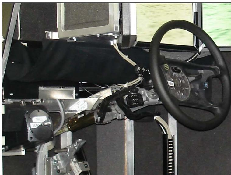
Abbildung 17.5: Lenkradrückstellmomentmotor des dynamischen Fahrsimulators (MARS)
