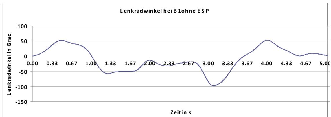
Abbildung 16.14: Lenkradwinkel vom ISO Fahrspurwechsel (ISO 3888-1) mit Conti Reifen ohne ESP
