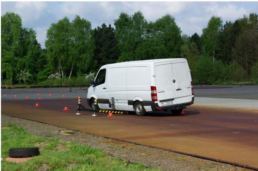
Abbildung 16.13: ISO Fahrspurwechsel (ISO 3888-1) auf der Teststrecke in Nordhorn
