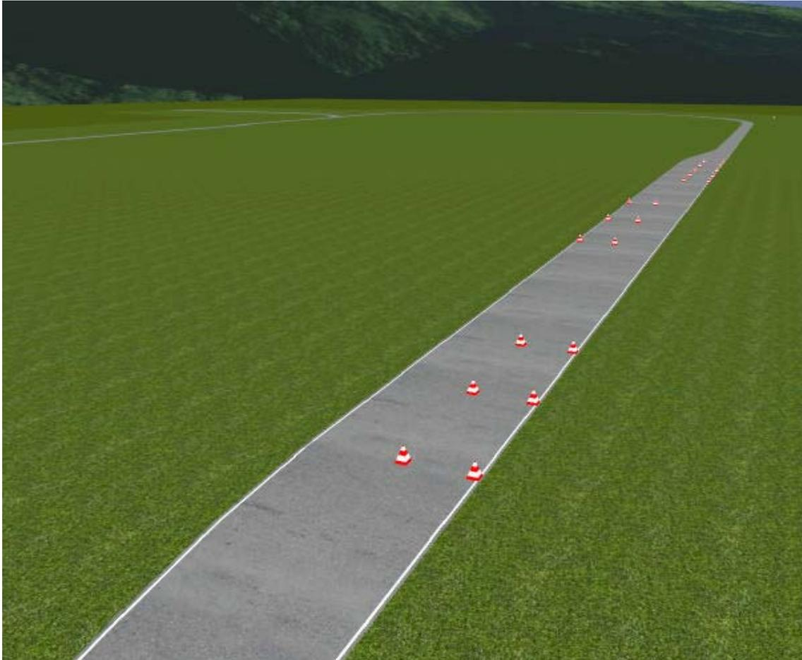
Abbildung 19.5: Screenshot des Szenarios aus der Vogelperspektive des ISO Fahrspurwechsels nach ISO 3888-1
