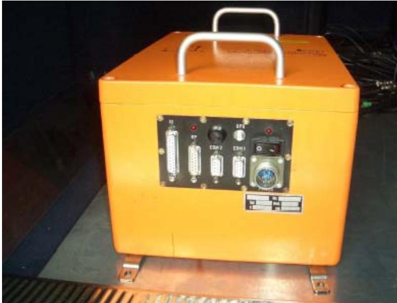
Abbildung 15.5: iMar-Inertial-Messplattform
