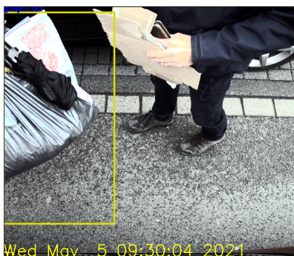
Bild 5-16: Plastiksack wird als Sinkkasten erkannt (Foto aus Pilotprojekt, iLocator)
