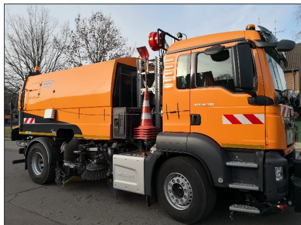
Bild 5-13: Provisorischer Anbau der Kameraeinheit an einer Großkehrmaschine der NLStBV (Eigenes Foto, DRC)
