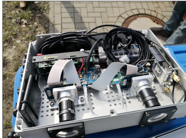
Bild 5-12: 3D-Kamera für den Einsatz im Pilotprojekt „Entwässerungsmanagement“ (Eigenes Foto, DRC)
