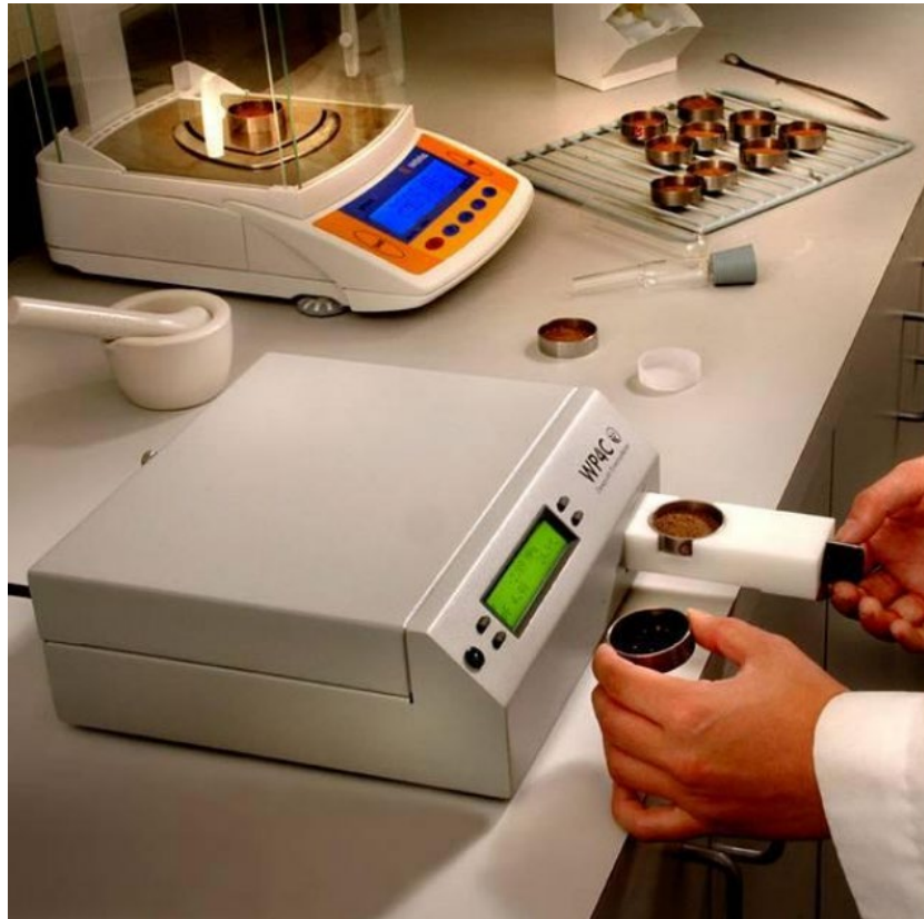
Abbildung 6: WP4C-Taupunkt-Potentiometer der Firma Decagon Devices. ( http://www.decagon.com/assets/Images/Product-Images/Water-Potential/wp4c2.jpg , 12.11.2013).
