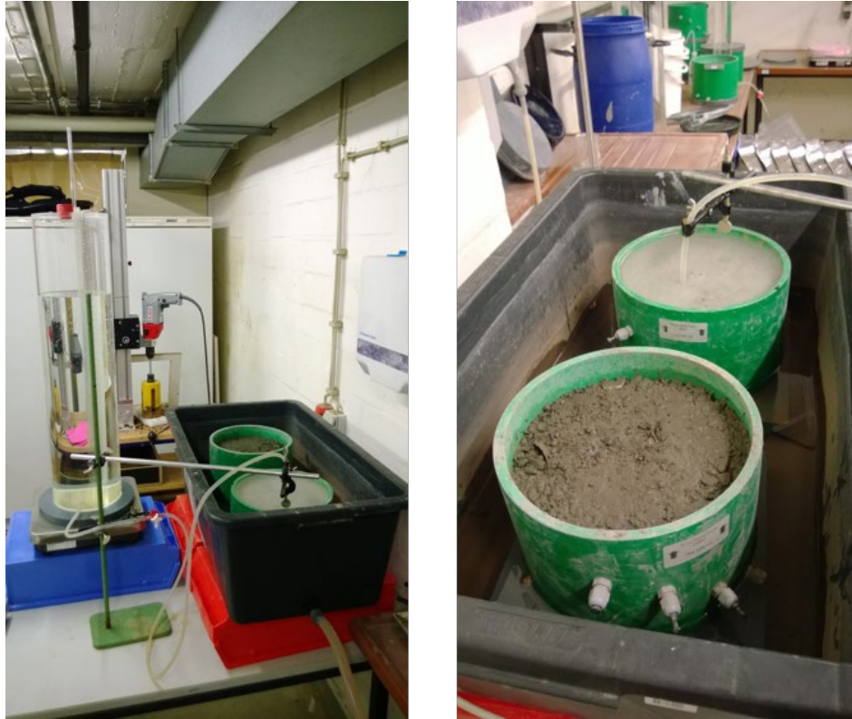
Abbildung 8: Versuchsaufbau bei der Durchführung der Experimente zur Bestimmung der gesättigten hydraulischen Leitfähigkeit der Materialien.
