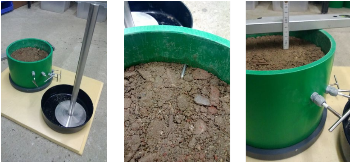
Abbildung 1: Einbau des Probenmaterials (RC2). Links: Metallstempel zur manuellen Verdichtung des Probenmaterials. Mitte: Eingeführter Metallstab als Platzhalter für die spätere Installation des Tensiometers. Rechts: Fertig eingebautes Probenmaterial nach Verdichtung der letzten Schicht.
