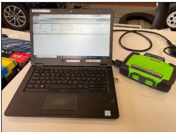
Bild 3-4: Mehrmarkendiagnosegerät von Bosch (KTS 590)
