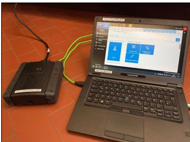
Bild 3-5: Diagnosesoftware IDC5 und Interface von Texa
