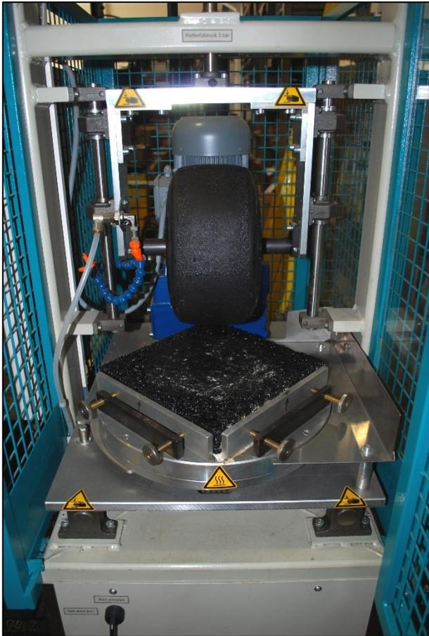
Bild 11: DSD-Prüfgerät im Laboratorium
