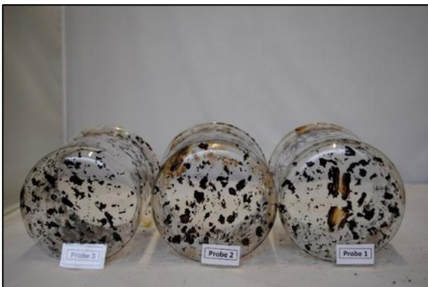
**Bild 24:** Bindemittelablauf mit losen Zellulosefasern
