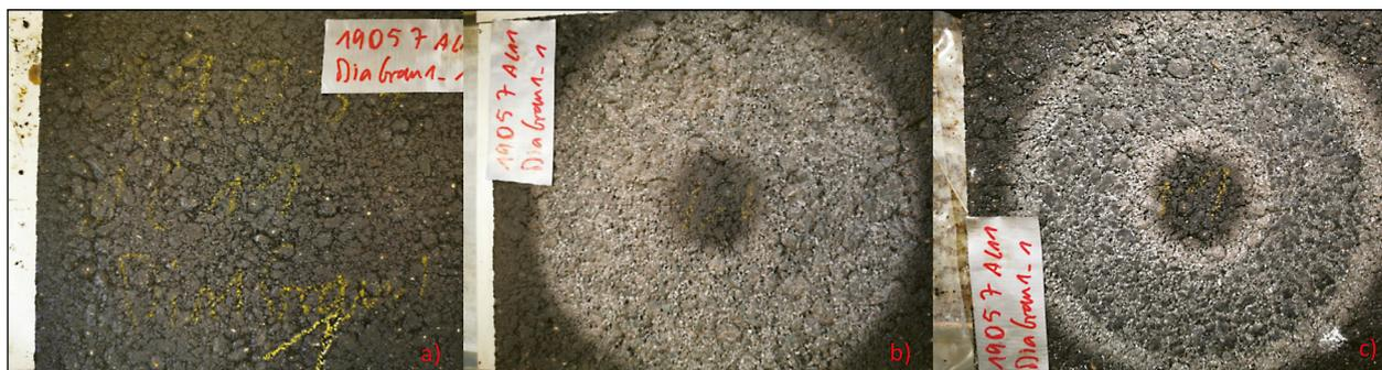
Bild 6-20: Asphaltprobekörper nach Herstellung (a), nach Sandstrahlen (b), nach Polieren (c)
