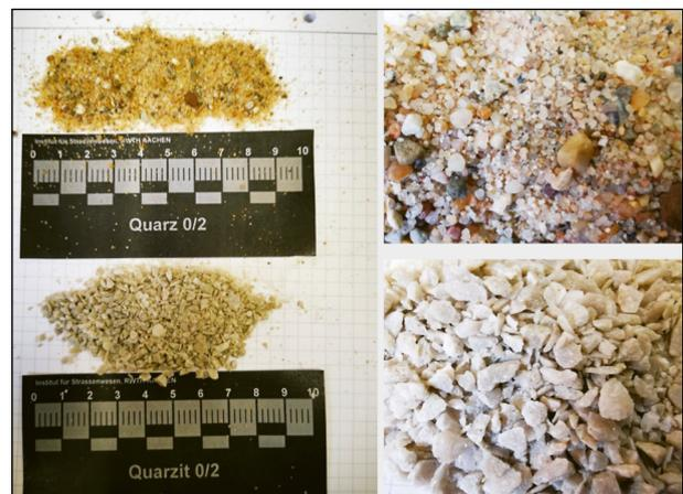
Bild 6-8: Kornform Quarzsand und Quarzit
