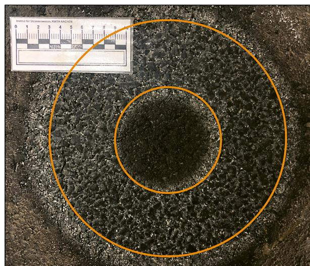
Bild 6-23: Im Kreisring dargestellte Prüffläche eines Probekörpers
