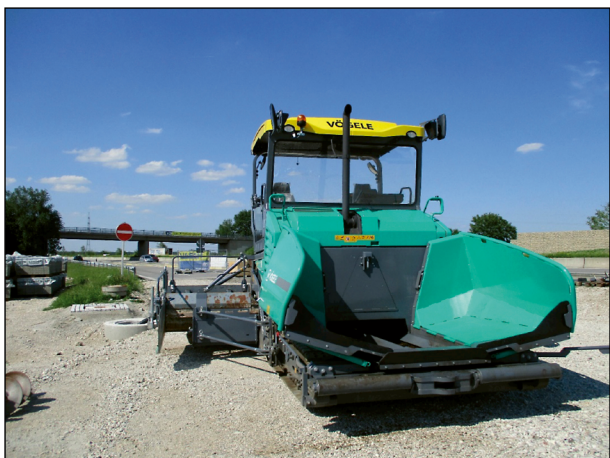
Bild 69: Straßenfertiger OPB Einbau (1)
