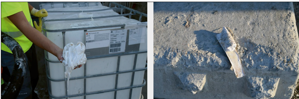
Bild 94: Ursachen für den Ausfall der Dispersionspumpe, in den Gebinden gebildete Haut (links) und der aus dem Ansaugschlauch entfernte Pfropfen (rechts)
