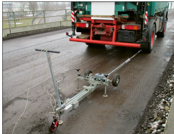
Bild 132: Belastungsfahrzeug mit Benkelman-Balken
