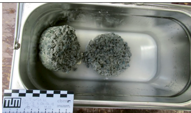
Bild 99: Ergebnis der Frostprüfung der aus der Strecke entnommenen Bohrkern (links) mit einem beispielhaften Versagensbild der Probe M12 (rechts)
