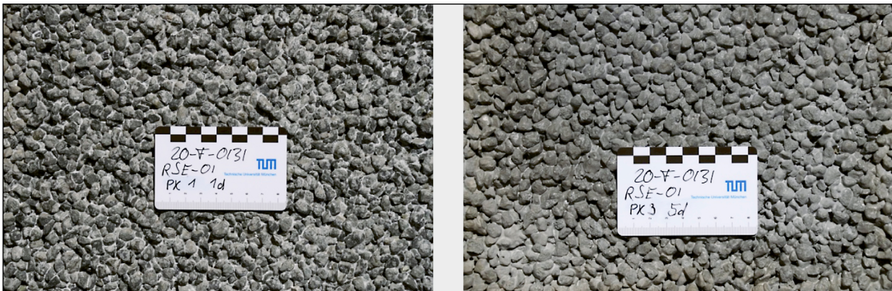
Bild 34: KSM1 Probekörper nach dem Auswaschen nach 24 h (links) und 120 h (rechts)
