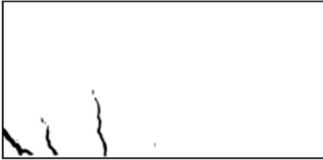
R22_DIC_F - Querkraft: 311.0 kN
