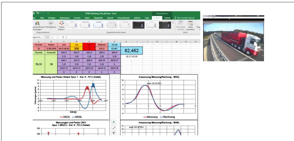
Bild 99: Visualisierung der Erkennung eines Fahrzeuges des Großraum- und Schwerlastverkehrs
