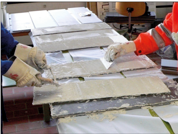
Bild 56: Herstellung der Probekörper
