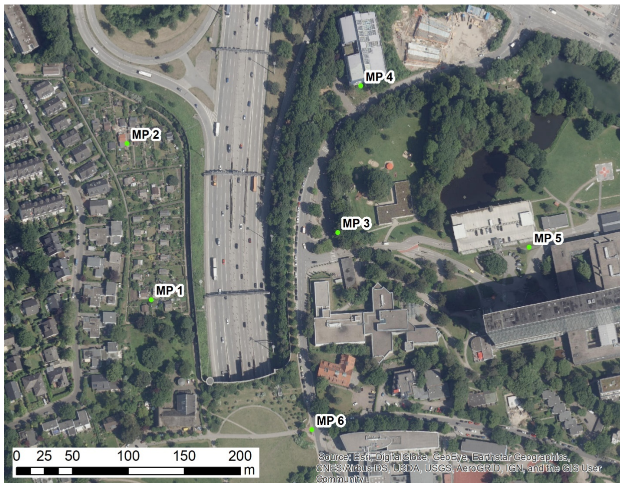
Abbildung 3-9: Lage der Messpunkte im Bereich des Nordportals des Elbtunnels in Hamburg
