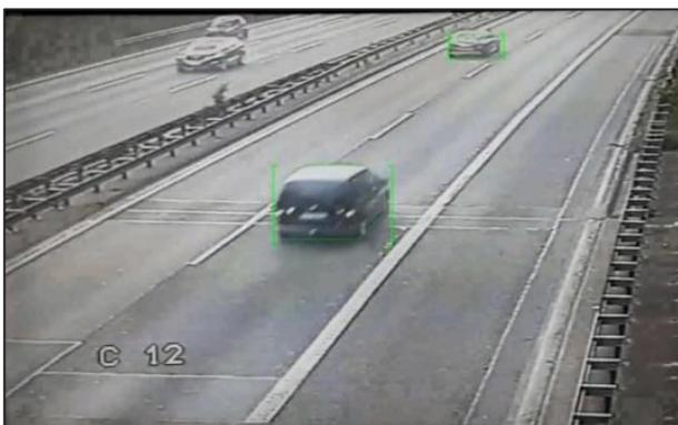
Bild 3-6: Videoframe eines abgefilmten Monitors, Kamerabild 12 und zwei automatisch detektierte Fahrzeuge (Video: Straßen.NRW)
