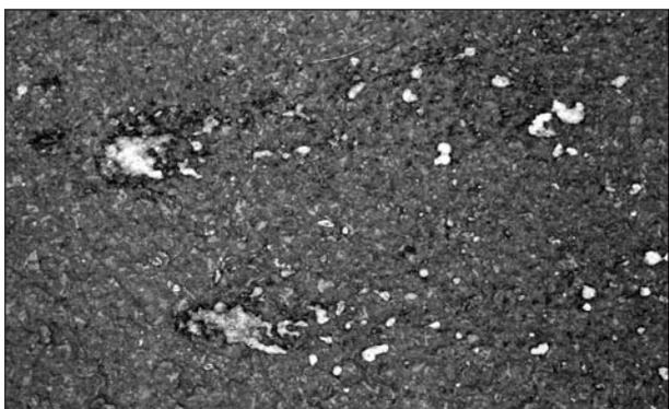
**Bild 5:** Verteilung des von Hand ausgebrachten Feuchtsalzes
