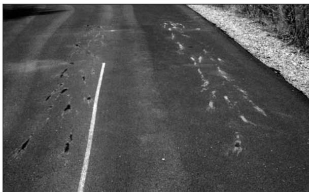
**Bild 8:** Flächen nach dem Kehren mit Lösungsschlieren bei den Versuchen in der BAST
