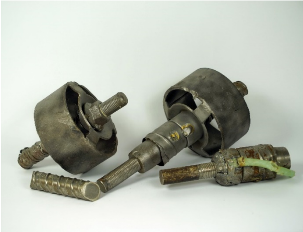
Bild 4-6: Glockenverankerung des DYWIDAG-Spannsystems (© Gregor Schacht)
