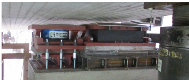
Bild 3-37: Verschublager mit Bremslager (© HOCHTIEF)
