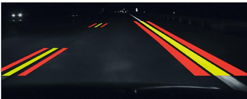
Maschinell detektierte Fahrbahnmarkierungen bei nächtlicher Fahrt auf einer Autobahn (Bild: ISAC GmbH, Aachen)
