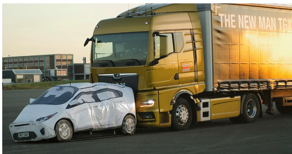
Aktueller MAN TGX, voll beladen, bei einer Bremsung aus 90 Kilometer pro Stunde auf das stehende Fahrzeug-Zielobjekt, das hier mit 10 Kilometern pro Stunde Restgeschwindigkeit leicht touchiert wurde – Vorversuche der BAST für Euro NCAP im November 2021
