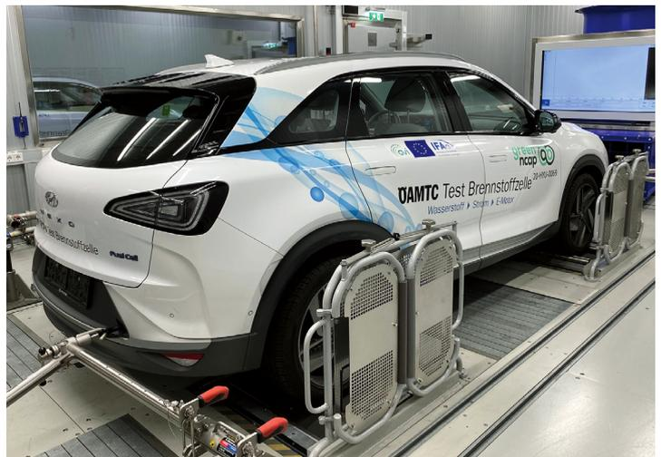
Testfahrzeug auf dem Rollenprüfstand (Bild: Green NCAP)
