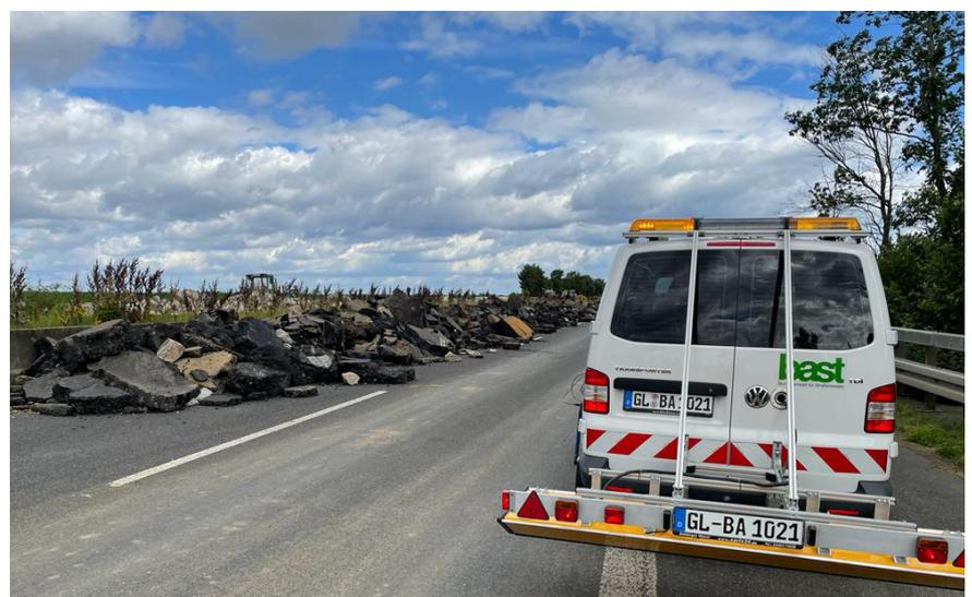
BASt-Messfahrzeug mit am Heck montierter 3D-Georadarantenne..
