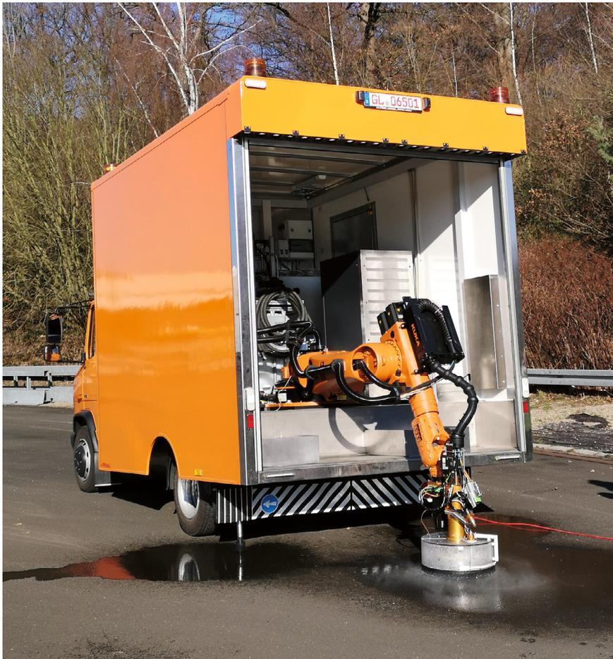
*Mobile Wehner-Schulze-Anlage mit Roboter im Messfahrzeug im Einsatz*
