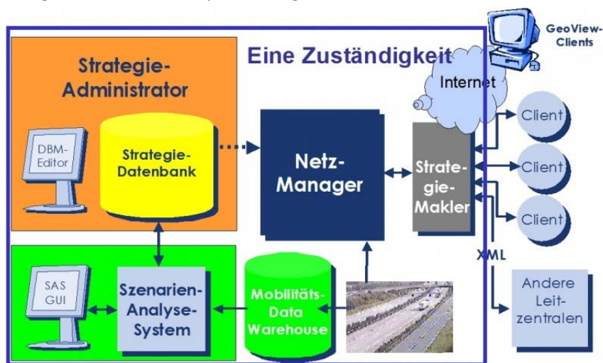
Bild 27: Komponenten des ISM (Quelle: Hessen Mobil)
