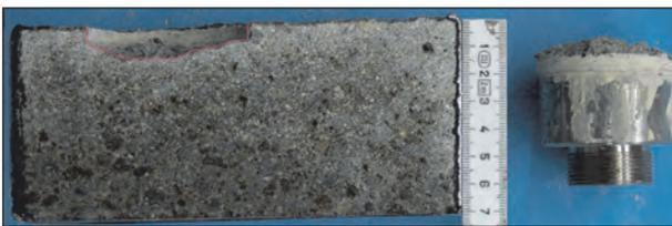
**Bild 30:** Kohäsionsbruch der befrostenen Probe WaBe A4-II-15 (Betonalter: 9 d)
