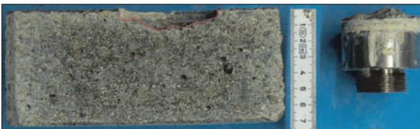
**Bild 29:** Kohäsionsbruch der unbefrostenen Probe WaBe A4-II-6 (Betonalter: 9 d)
