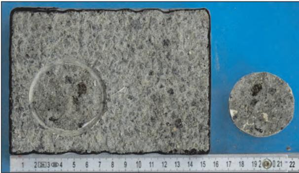
**Bild 28:** Kohäsionsbruch der oberflächennahen Schicht der Probe WaBe A8-18 (Betonalter: 9 d)
