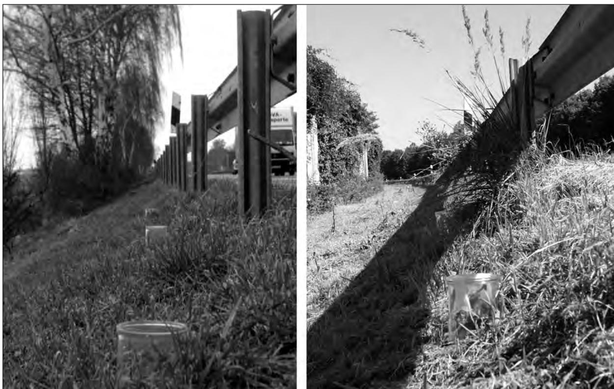
**Bild 8:** Berghoffgefäße bodennah aufgestellt in 1 m Entfernung von der Fahrbahnkante, Westseite der A 555 und Nordseite der A 4
