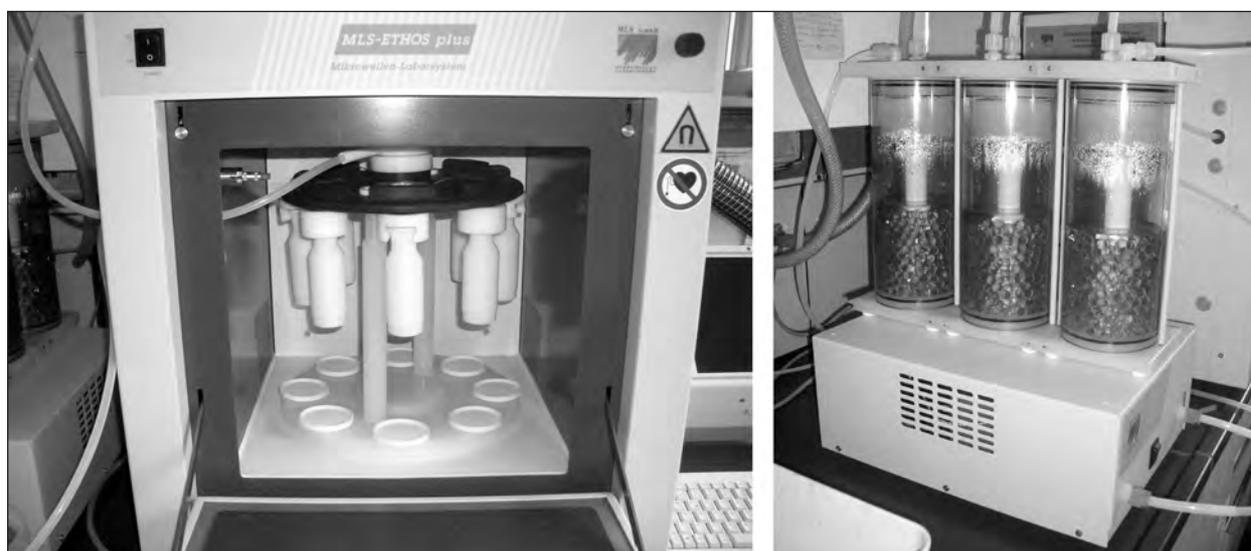
Bild 10: Mikrowellen-Aufschlussanlage (links) mit nachgeschaltetem Flusssäure-Wäscher (rechts)
