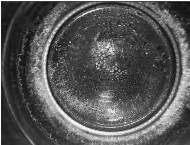
**Bild 30:** Depositionsgefäß nach Probenahme und Trocknung, in der Mitte sind kubische Natriumchloridkristalle zu erkennen
