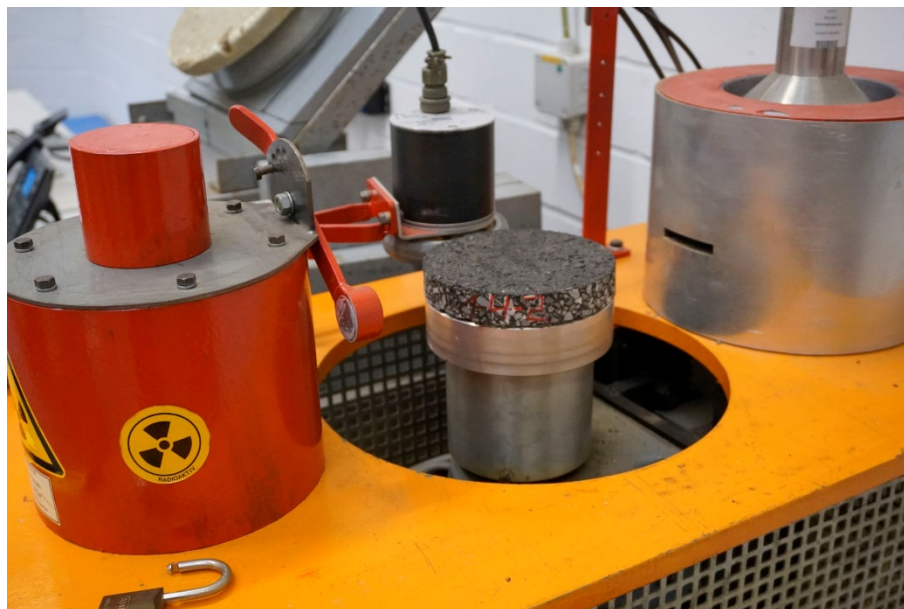
Bild 4-11: Durchstrahlungseinrichtung mit Bohrkern auf Drehteller
