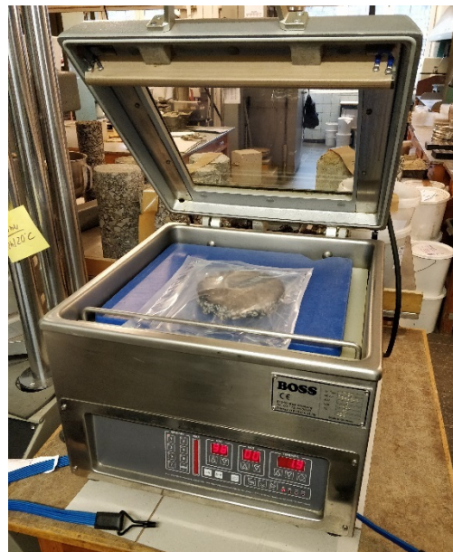
Bild 4-7: Im Projekt verwendete Vakuummaschine vom Typ NT 21 der Fa. Boss Vakuum
