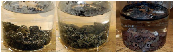
Bild 46: Bindemittelablösung nach 6 h bei 60 °C durch Di-Natriumhydrogenphosphat (von links Diabas, Grauwacke, Quarzit)
