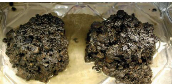
Bild 31: MPK AC 16 BS, Quarzit, k = ca. 85 % nach 96 h statischer Wasserlagerung bei 60 °C
