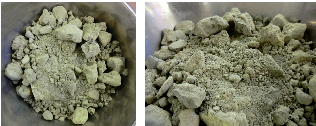
Bild 4.7: tertiärer Ton, aufbereitete Proben < 31,5 mm
