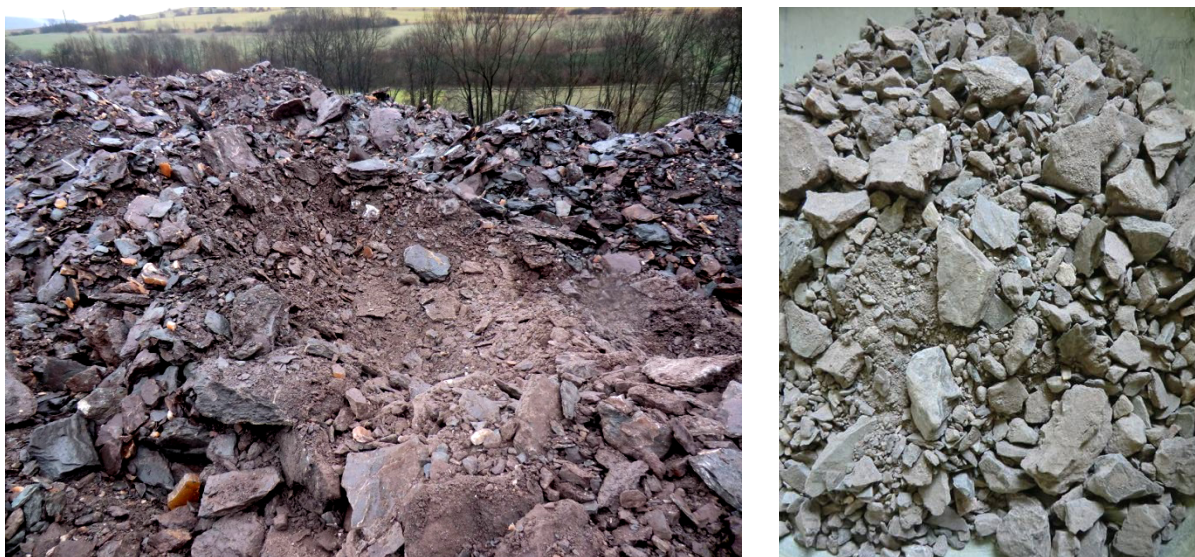
Bild 4.6: Tonmergelstein, Entnahmestelle Zwischenlager (links) und aufbereitete Proben < 31,5 mm (rechts)
