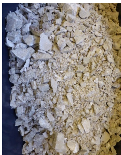
Bild 4.2: Bentonit, Entnahmestelle Aushub (links) und aufbereitete Proben < 31,5 mm (rechts)
