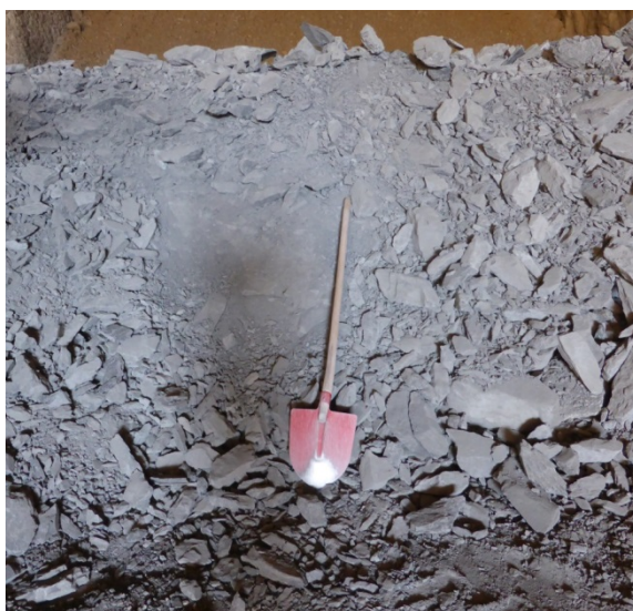
Bild 4.1: Opalinustonstein, Entnahmestelle Zwischenlager (links) und aufbereitete Proben < 31,5 mm (rechts)
