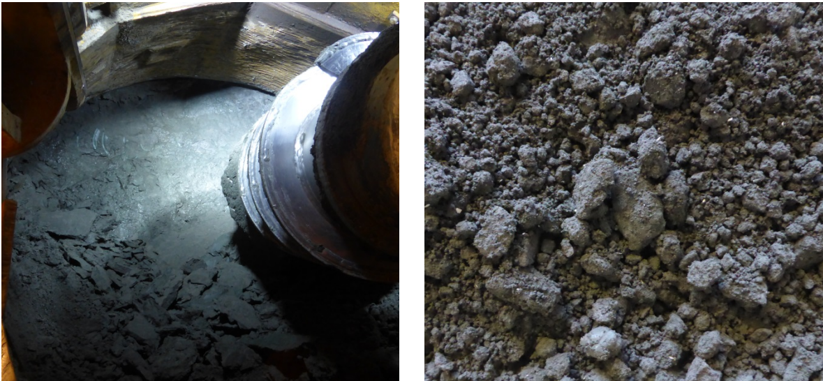
Bild 4.4: Emscher Mergel, Entnahmestelle an der Ortsbrust (links) und aufbereitete Proben < 31,5 mm (rechts)
