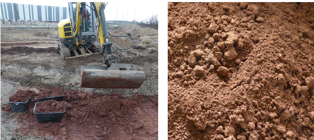
Bild 4.5: Feuerletten-Zersatz, Entnahmestelle nahe Geländeoberfläche (links) und aufbereitete Proben < 31,5 mm (rechts)
