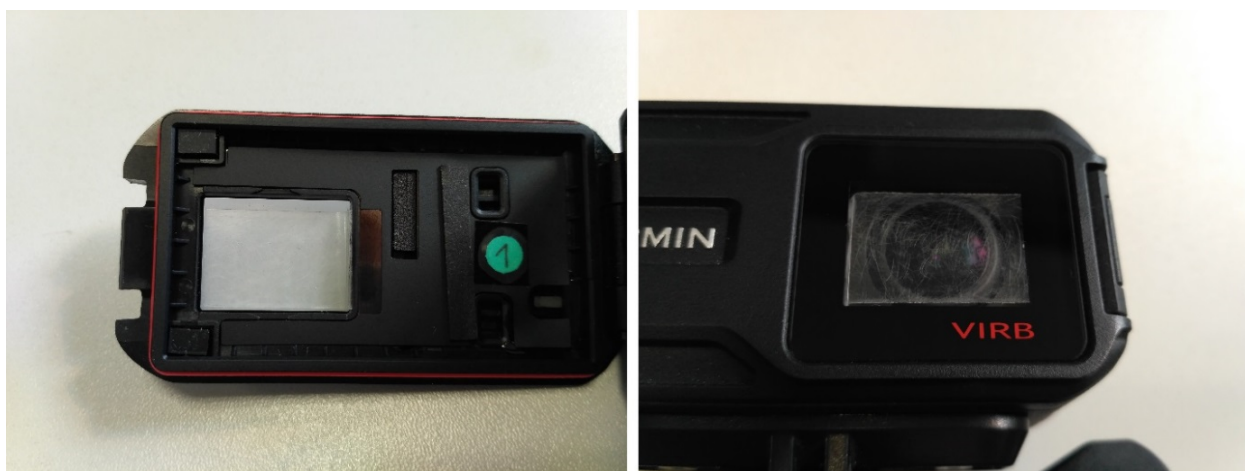
Bild 1: Datenaufzeichnungsgerät VIRB X mit Folie zur Heruntersetzung der Bildqualität.
