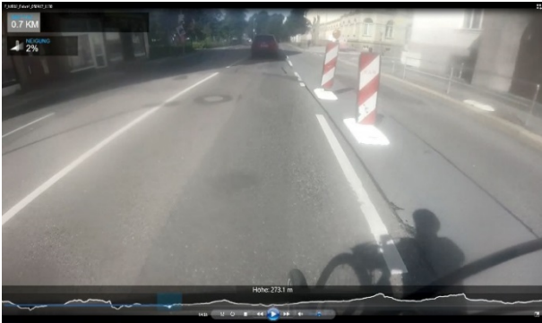
Bild 9: Screenshot eines exportierten Videos mit Informationen zu Neigung, Höhe, Höhenprofil und zurückgelegter Distanz.
