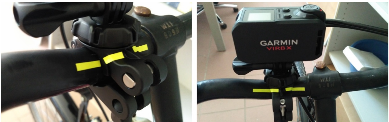
Bild 4: Sicherstellung der korrekten Ausrichtung des Datenaufzeichnungssystems bei An- und Abbau durch den Probanden bei Nutzung der ursprünglich gewählten Halterung vom Garmin.
