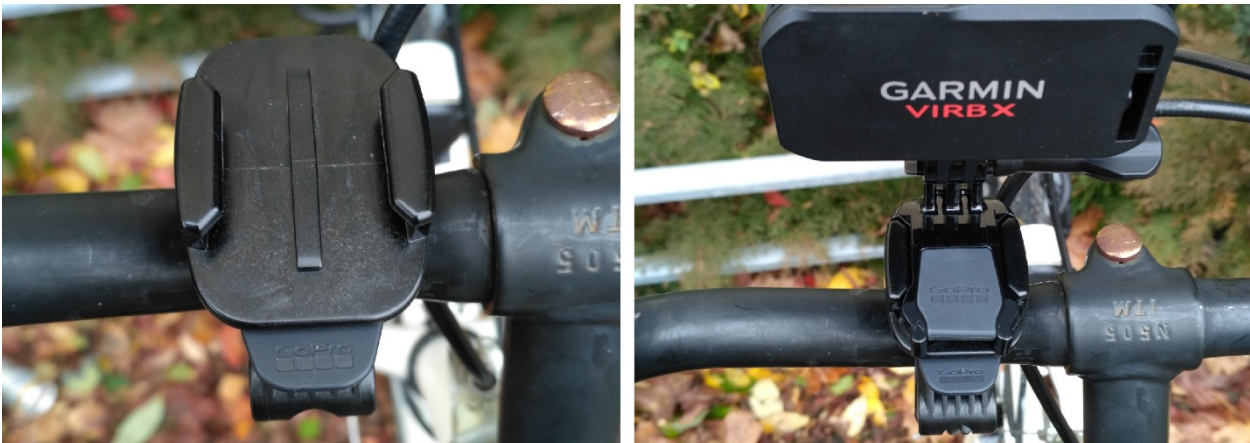
Bild 5: Basis der Cliphalterung am Lenker (links) und mit montiertem Datenaufzeichnungsgerät (rechts).
