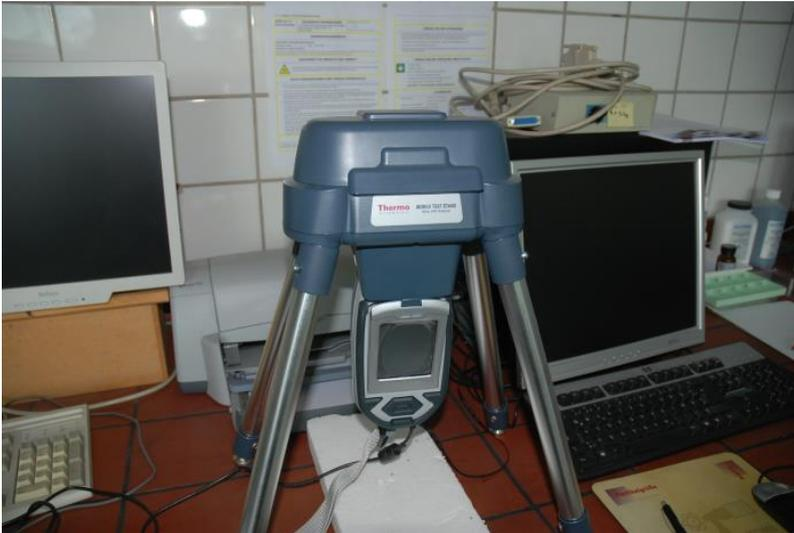
Bild 4-4: Verwendetes RFA-Handgerät
