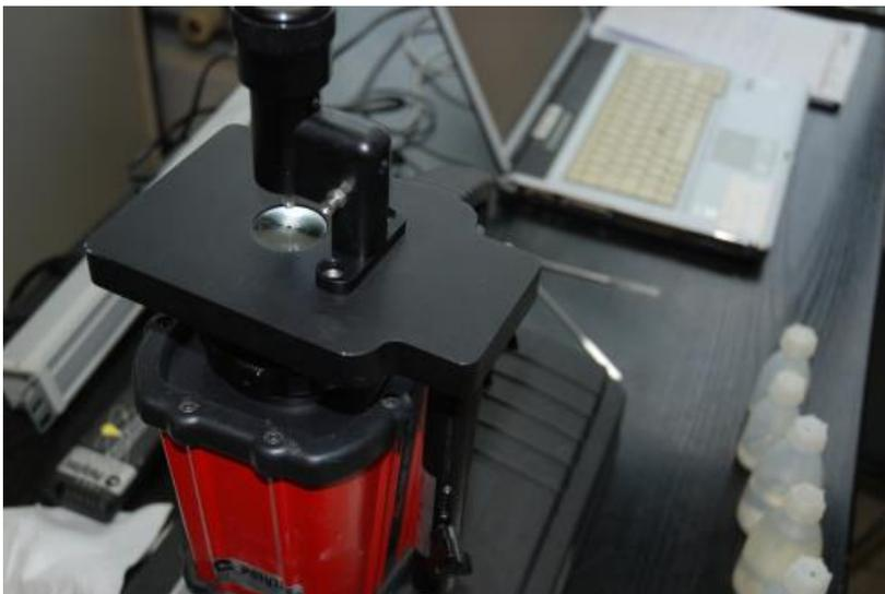
Bild 4-2: IR-Handspektrometer mit ATR-Zelle als Standby Gerät
