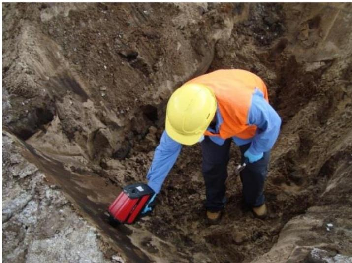
Bild 4-3: IR-Handspektrometer mit ATR-Zelle im Einsatz
