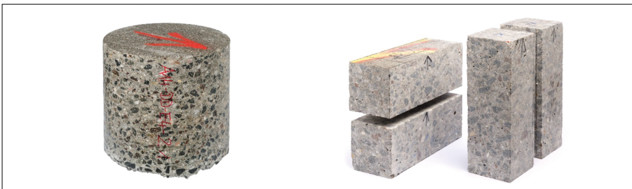
Bild 8-3: Prinzip zur Gewinnung von Probekörpern aus Bohrkernen mit Durchmesser 350 mm aus Plattenmitte.
