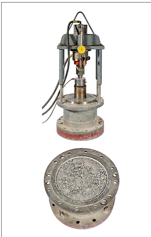
Bild 3-5: Versuchsaufbau einaxialer Kompressionsversuch (oben) und gefüllter Ödometertopf (unten).
