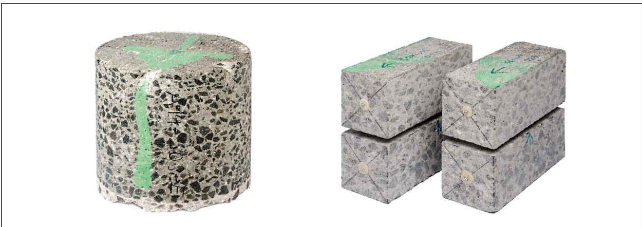
Bild 3-1: Prinzip zur Gewinnung von Probekörpern aus Bohrkernen (Durchmesser 350 mm).
