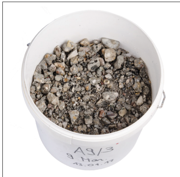
Bild 3-4: Über den Prüfzeitraum im Eimer befeuchtetes RC-AKR-Material für die AKR-provozierende Lagerung im Klima (40/100).
