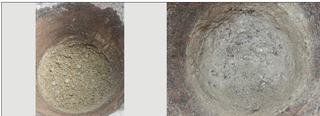
Bild 6-6: Reprofilierter RC-ToB im Bohrloch 2 (links) und verfestigte RC-AKR-ToB im Bohrloch 2 nach Entfernen der rd. 15 cm starken reprofilierten RC-ToB (rechts).
