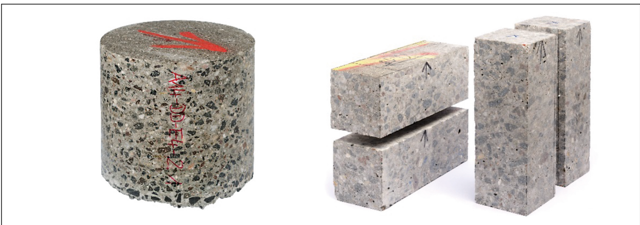
Bild 3-2: Prinzip zur Gewinnung von Probekörpern aus Bohrkernen.
