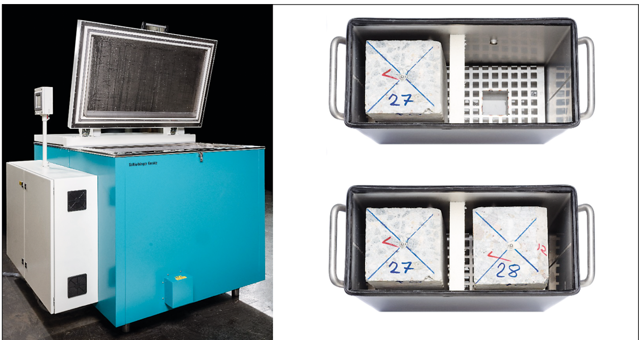
Bild 3-3: Schleichinger Truhe zur Bestimmung der Nachdehnung (links), angepasste Edelstahlbehälter für die prismatischen Prüfkörper mit den Abmessungen 10 x 10 x 28 cm 3 (rechts).
