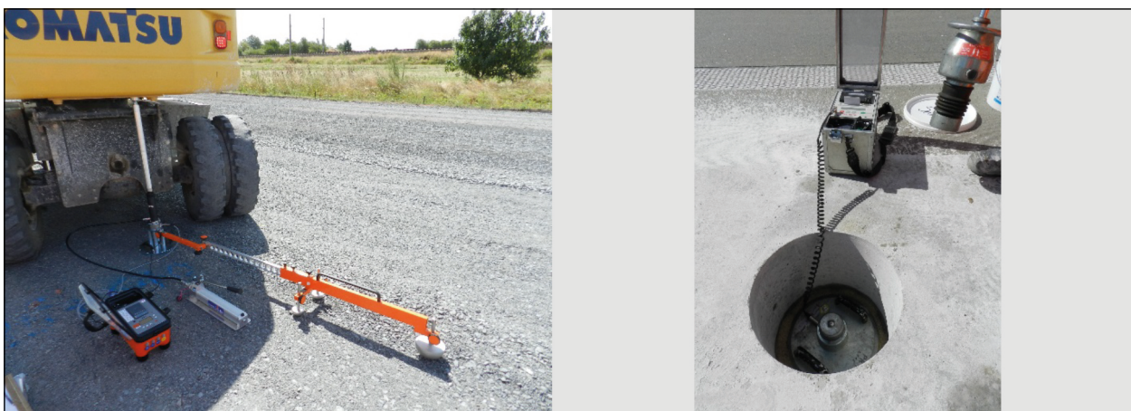
Bild 3-7: Statische Plattendruckversuch auf einer ungebundenen Tragschicht (links) und dynamischer Plattendruckversuch im Bohrloch auf einer ungebundenen Tragschicht (rechts).
