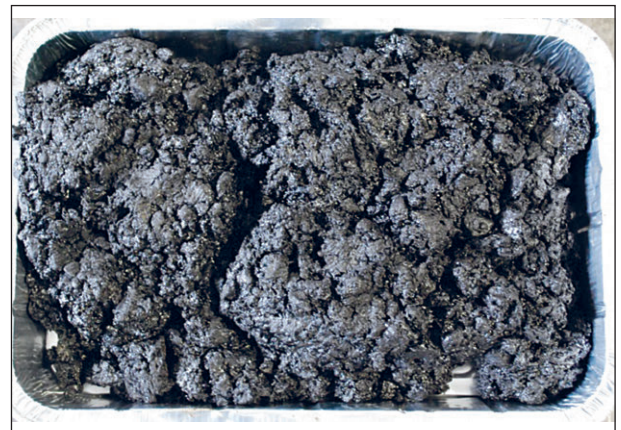
Bild 44: Gussasphalt-Variante A11 F3 nach dem Mischen
