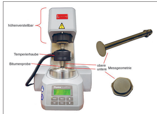
Bild 23: Dynamisches Scher-Rheometer (DSR) inkl. Messgeometrie
