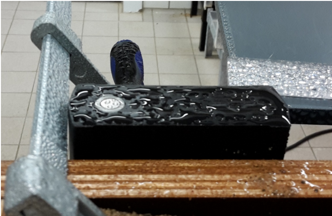
Bild: Nach Abtrocknung mit Tuch, kein Fingerkontakt, dritter Sprühvorgang Ergebnis WFD-Messung: Anforderungen nicht erfüllt
