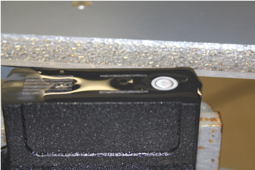
Bild: Sensor nach dem Schleifen und Kalibrieren Ergebnis WFD-Messung: Anforderung erfüllt
