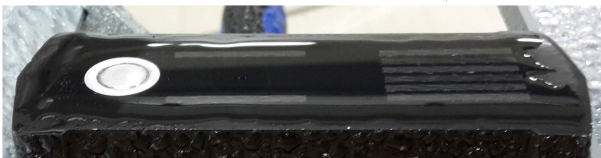
Bild: DRS511 vom 17.03.2016 mit WFD von 0,2 mm nach Glättung mit Stab
