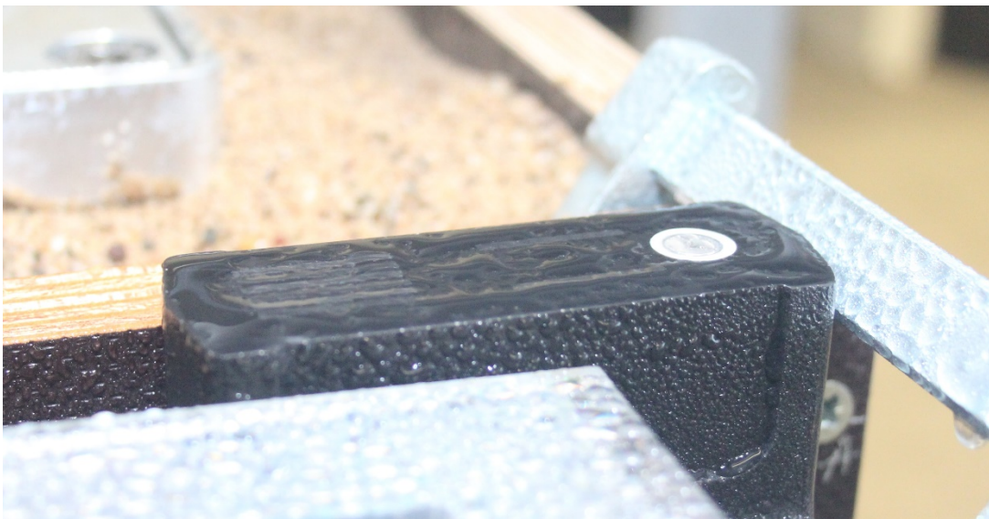
Bild: Nach Abtrocknung mit Tuch, kein Fingerkontakt, zweiter Sprühvorgang Ergebnis WFD-Messung: Anforderungen nicht erfüllt
