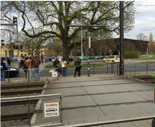
**Bild 42:** Hinweisschild mit Sinnbild „Straßenbahn“ nach StVO nach StVO und Zusatzhinweisen – Montage an einem seitlich liegenden Absperrgitter (Hannover)
