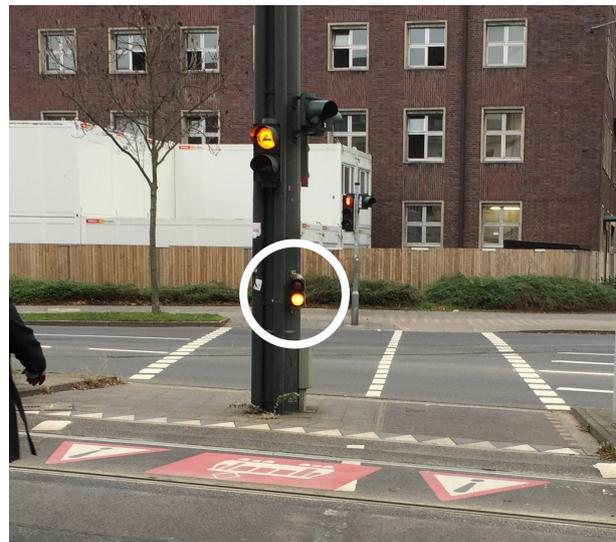
**Bild 35:** Gleisquerung mit Zusatzsignalgebern in geringer Höhe (Düsseldorf)
