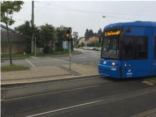
**Bild 27:** Beispiel für ein Springlicht mit übereinanderliegenden Signalgebern, 200 mm Leuchtfelddurchmesser (Kassel)
