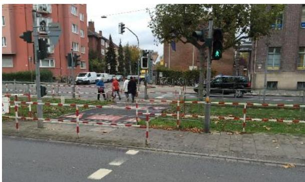
**Bild 45:** Rot-weiß gestreifte Umlaufsperrn an einer Gleisquerung (Düsseldorf)
