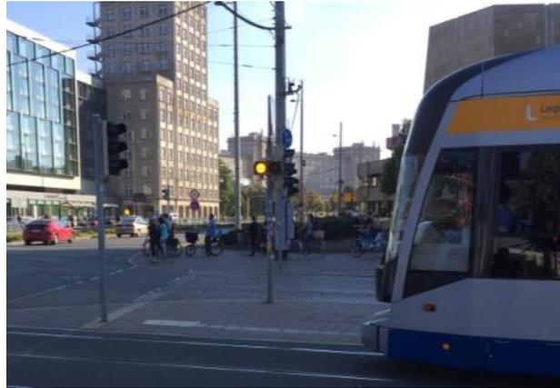
**Bild 28:** Beispiel für ein Springlicht mit nebeneinanderliegenden Signalgebern, 200 mm Leuchtfelddurchmesser (Leipzig)
