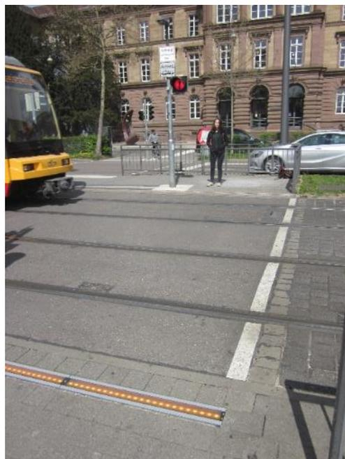
**Bild 22:** Bodenwarnleuchten mit gelbem Signal und Lichtsignal mit Signalisierung Rot (Karlsruhe)
