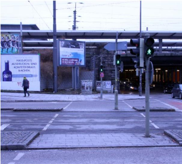
**Bild 34:** Signalisierung der Gleisquerung mit ROT-GRÜN im Zuge einer signalisierten Querung an einem Knotenpunkt (München)
