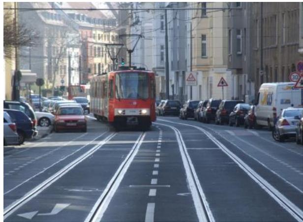
**Bild 1:** Beispiel für eine Straßenbahn auf straßenbündigem Bahnkörper
