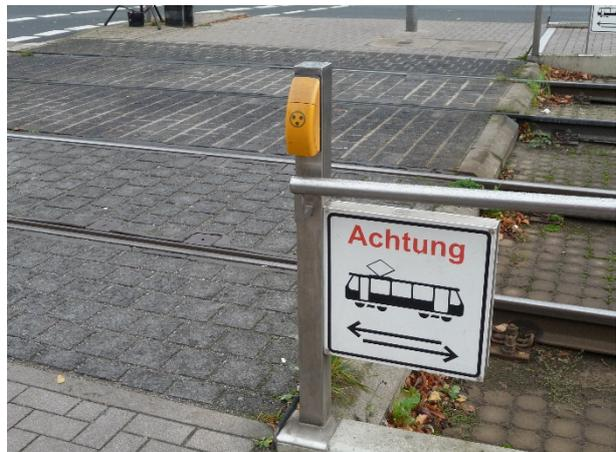
**Bild 105:** Anforderungstaster an einer Gleisquerung (Beispiel Stadt D)
