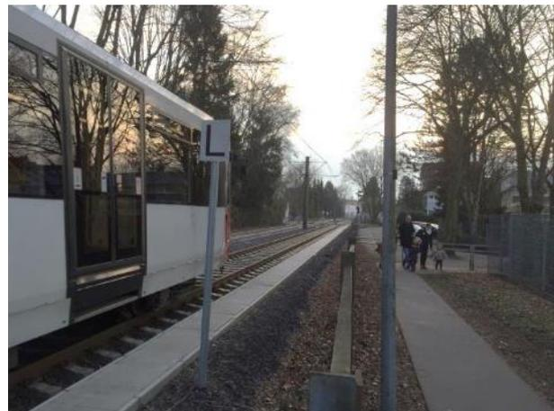
**Bild 50:** Schutzsignal Sh4 „Läuten“ vor einem Bahnübergang für Fußgänger bei Sicherung durch „Übersicht auf die Bahnstrecke“
