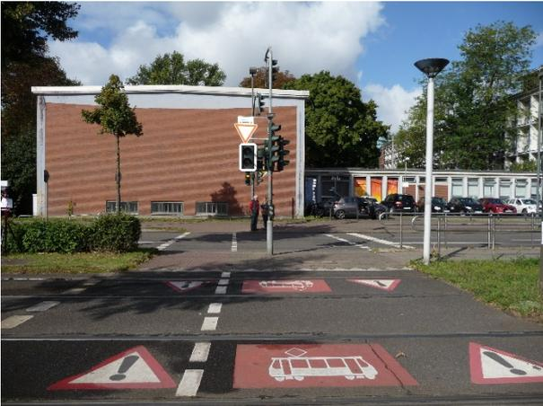
**Bild 109:** Beschilderung und Markierung der Gleisquerung (Beispiel Stadt C)
