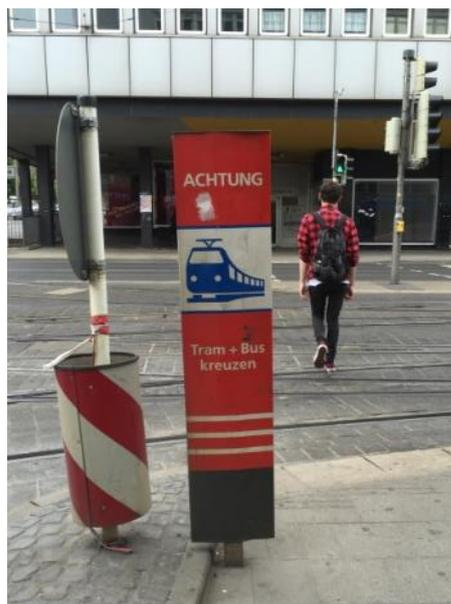
**Bild 40:** Stèle mit Warnhinweis und Sinnbild „Schienenbahn“ vor einer Gleisquerung – Aufstellung am Rand der Gleisquerung (Kassel)
