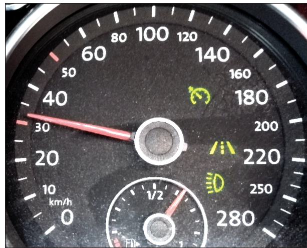
Bild 43: Symbole (Tempomat und Spurhaltung) im Instrumenten-Kombi bei aktivem automatisiertem System in der Realstudie
