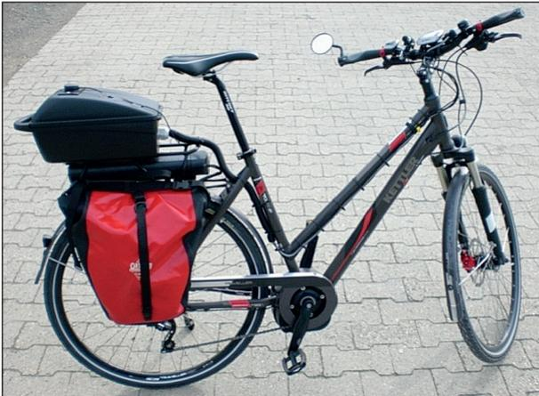
Bild 29: Elektrofahrzeug mit fest installiertem Messequipment
