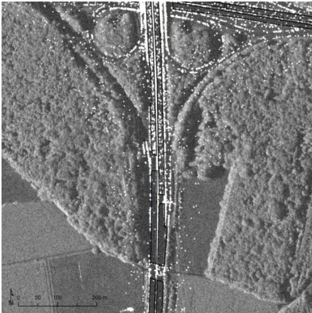
Bild 20: Links Messpixeldichte auf der Autobahn A7 südlich Autobahnkreuz Hannover Ost (aufsteigender Orbit, Einfallswinkel 53,81°) © DLR e.V. 2014 und © Airbus DS Geo GmbH 2014. Deutliche Unterschiede sind zwischen dem SMA 11 auf Brücken und dem Grindingbeton (wenig Punkte) erkennbar. Diese unterschiedlichen Straßenbeläge sind auch im Luftbild (© Google Earth 2014) rechts sichtbar.
