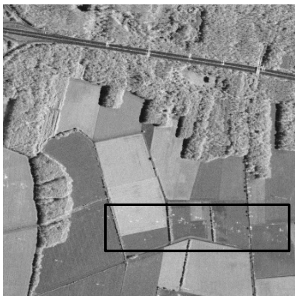
Bild 7: Reflexionen von Fahrzeugen mit Bewegung hauptsächlich 90° zur Satellitenflugrichtung (weiße Punkte parallel zur Autobahn auf den Feldern) – Autobahn A2 östlich des Autobahnkreuzes Hannover Ost. Ausschnitt TSX HS gemitteltes Amplitudenbild (absteigender Orbit, Einfallswinkel 31,14°) © DLR e.V. 2014, Distribution Airbus DS Geo GmbH.
