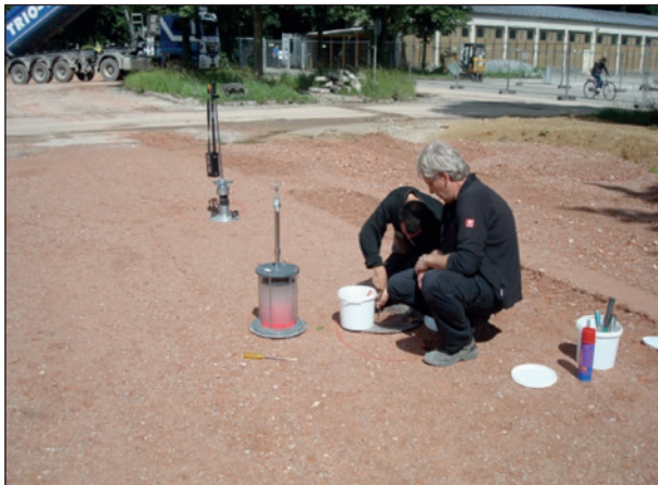
Bild 168: Mitarbeiter des ZG bei der Durchführung von Densitometerversuchen
