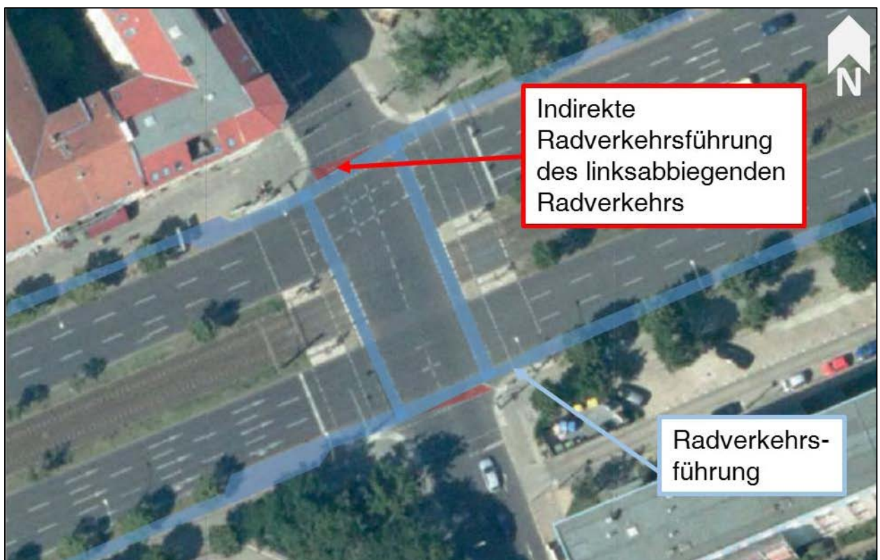
Bild 67: Indirekte Radverkehrsführung am Knotenpunkt Storkower Straße auf der Landsberger Allee in Berlin (u), Eigene Bearbeitung auf Kartengrundlage: Geoportal Berlin / Digitale Orthophotos 2015 (DOP20RGB), Bildaufnahmedatum 2015, http://fbinter.stadt-berlin.de/fb/?loginkey=showMap&mapId=k_luftbild2015_rgb@senstadt
