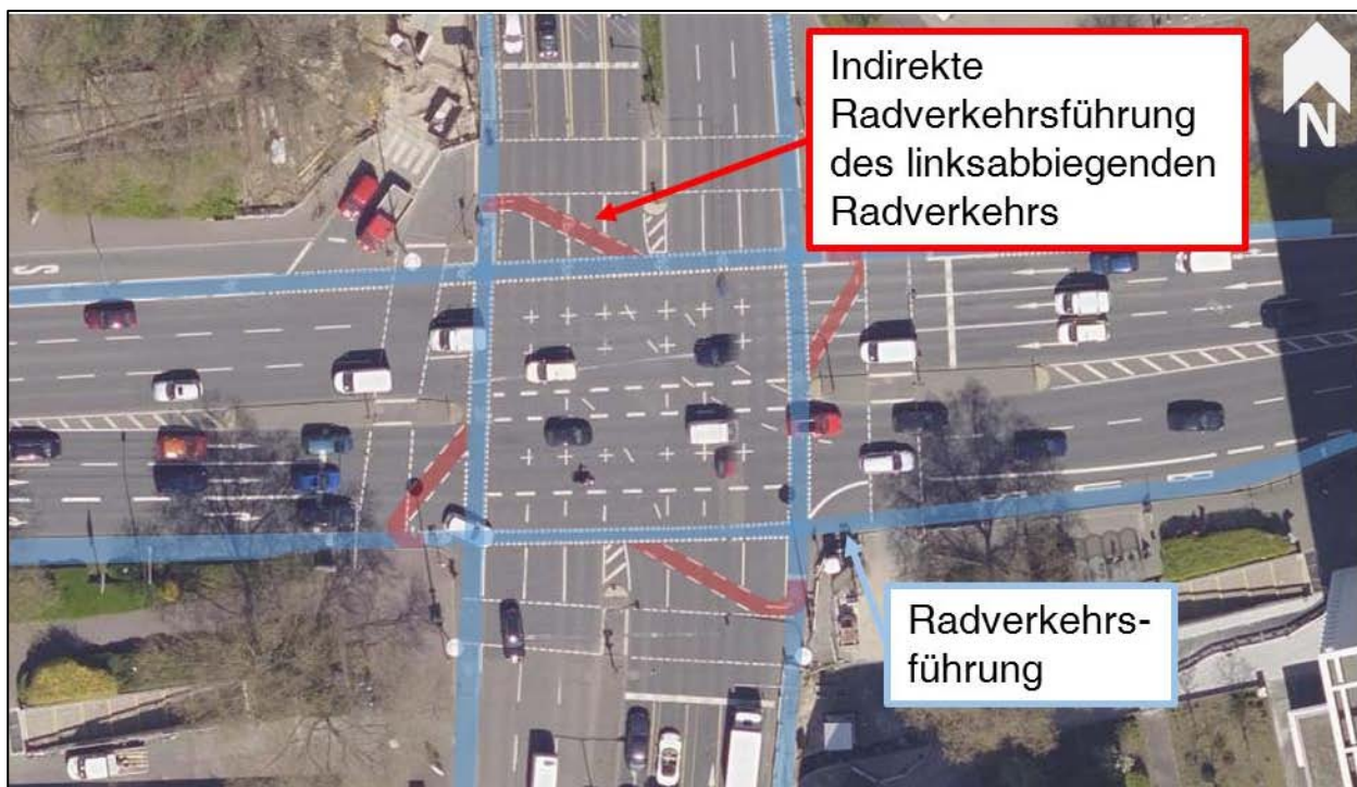
Bild 69: Indirekte Radverkehrsführung am Knotenpunkt Eschersheimer Landstraße auf der Miquelallee in Frankfurt (u), Eigene Bearbeitung auf Kartengrundlage: © Stadtvermessungsamt Frankfurt am Main, Bildaufnahmedatum 2017, https:// geoinfo.frankfurt.de/mapbender/application/stadtplan?visiblelayers=866/4236&scale=2500&center=477190,5551460
