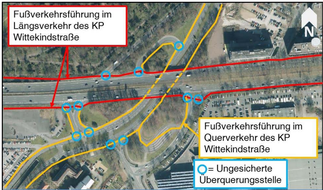
Bild 70: Fußverkehrsführung im Längs- und Querverkehr am Knotenpunkt Wittekindstraße auf dem Rheinlanddamm in Dortmund (u), Eigene Bearbeitung auf Kartengrundlage: Bezirksregierung Köln, www.govdata.de/dl-de/by-2-0 , https://www.wms.nrw.de/geobasis/wms_nw_dop20
