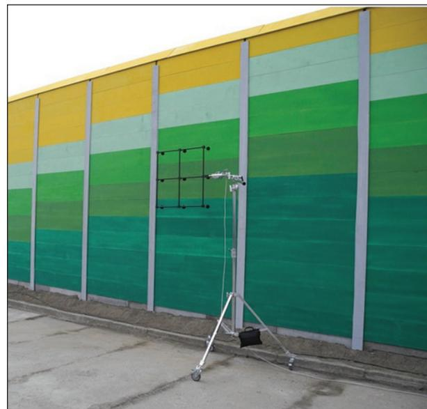
Bild 2.21: Rückseitiger Messaufbau zur In-situ-Bestimmung des Schalldämmungsindex von Lsw durch Einsatz des Messsystems AcoustiAdrienne der Gesellschaft für Akustikforschung Dresden mbH gemäß [DIN EN 1793-6]
