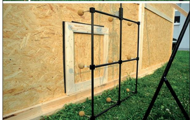
Bild 5.8: Rückseitiger Prüfaufbau für Messung an Test-Lsw mit Mikrofongitter in drei unterschiedlichen Höhen
