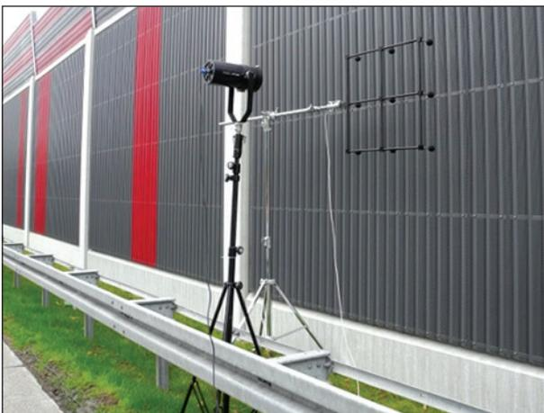
Bild 2.18: Messaufbau zur In-situ-Bestimmung des Schallreflexionsindex von Lsw durch Einsatz des Messsystems AcoustiAdrienne der Gesellschaft für Akustikforschung Dresden mbH gemäß [DIN EN 1793-5]
