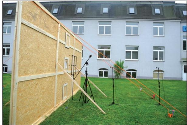
Bild 5.7: Rückseitiger Prüfaufbau für Messung an Test-Lsw mit Mikrofongitter und zwei Einzelmikrofonen
