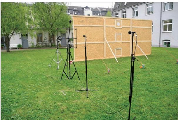
Bild 5.5: Messaufbau für Freifeldmessung bestehend aus Quelle, Mikrofongitter und zwei Einzelmikrofonen
