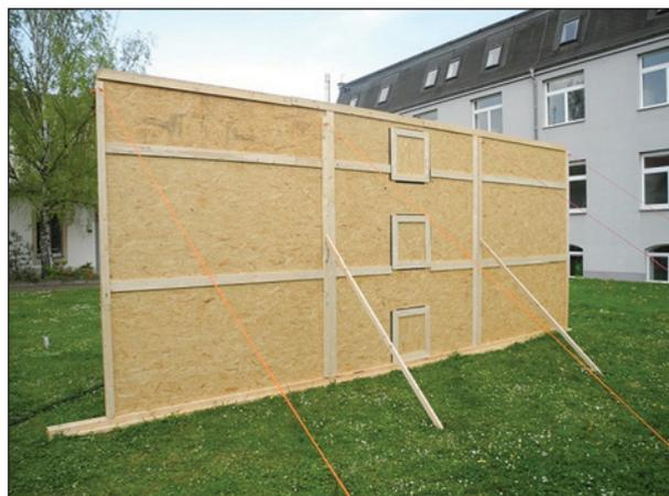
Bild 5.3: Aufgebaute intakte Test-Lsw mit geschlossenen Leckagefenstern
