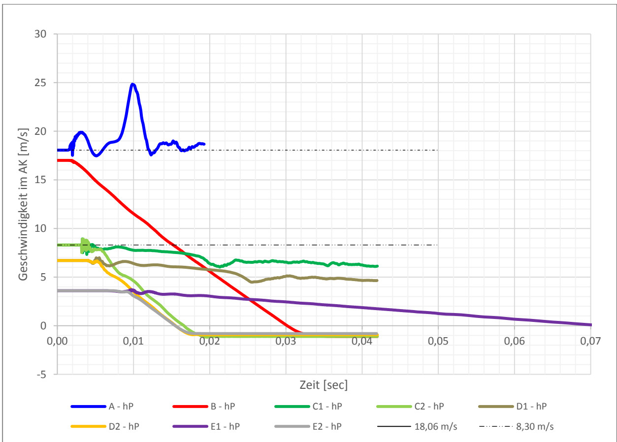
Abbildung 72 – Verlauf der Geschwindigkeit des Anprallkörpers (AK), punktuell aufgenommen in der hinteren Platte (hP) im Vergleich zu den Referenzgeschwindigkeiten von 18,06 m/s und 8,3 m/s
