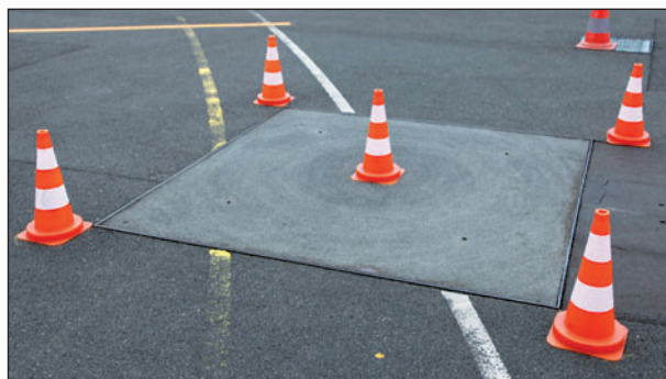
Bild 18: Enger Raum mit Begrenzungsquadrat (2,40 m x 2,40 m) und zu umfahrendem Verkehrsleitkegel in der Mitte.
