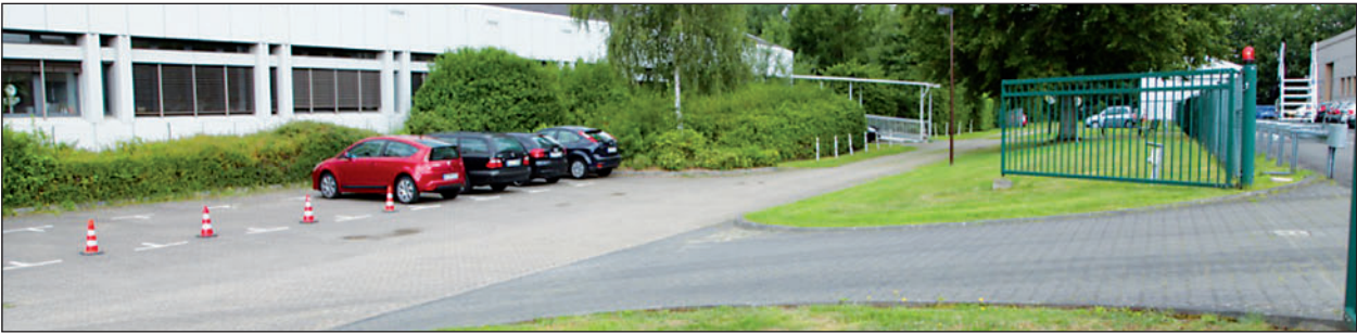
Bild 20: Rampe mit 10 % Steigung und 9,70 m Länge.
