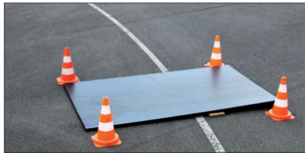
Bild 22: Wackelbrett (2,50 m x 1,50 m x 0,03 m) mit Begrenzungsleitkegeln.
