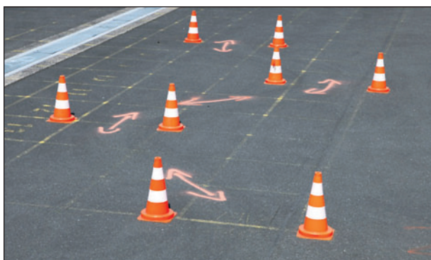
Bild 17: Ausweichgasse mit Verkehrsleitkegeln mit jeweils 1 m Abstand.
