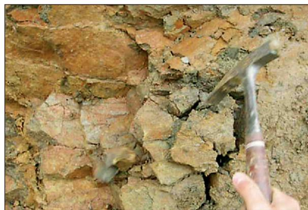
Bild 4.22: Böschungsanschnitt Tagebau im Gneiszersatz
