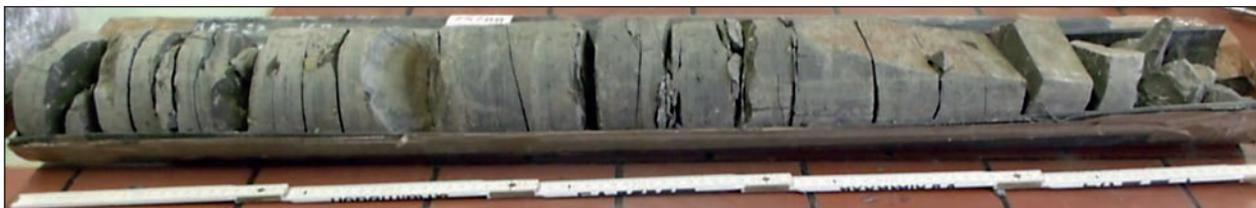
**Bild 4.24:** Mergelstein, stark zerklüftet bzw. geschichtet (keine Prüfkörper für einaxiale Druckversuche herstellbar; Proben für Eindringversuche zu fest)
