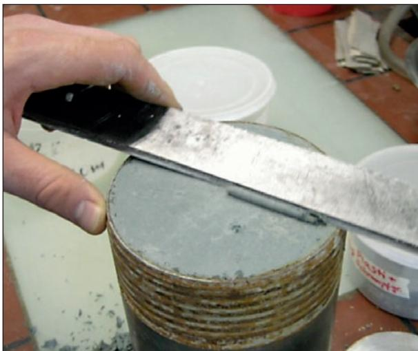
Bild 5.4: Herstellung einer glatten Oberfläche mittels Stahlhämmer für den Eindringversuch
