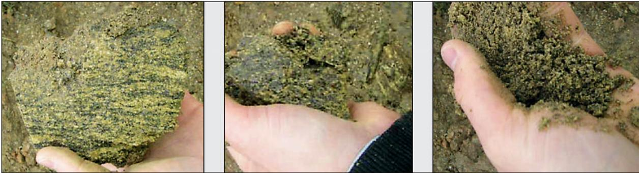
**Bild 4.23:** kleinere Brocken des Gneiszersatzes können mit leichtem Händedruck zerbröseln werden
