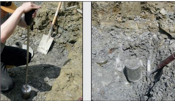
Bild 4.4: links: Einschlagen des Entnahmezylinders mittels Stange und Fallgewicht; rechts: ausgegrabener Entnahmezylinder
