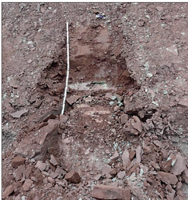
**Bild 4.15:** Entnahmestelle 1 („roter Mergelstein“ = Mst(I)) nach Baggeraushub, Entnahme von Blockproben
