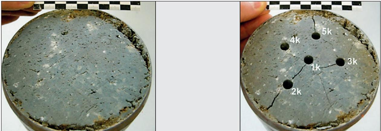
**Bild 5.14:** Beispiel Fotodokumentation Konus-Versuch OSM(III)-EZ3-1k bis -5k: Versuchsoberfläche vor (links) und nach (rechts) Versuch
