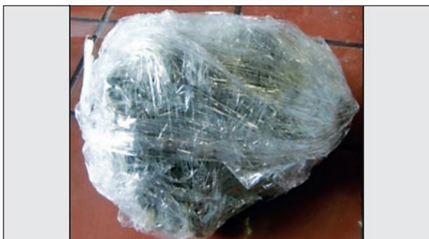
**Bild 4.6:** Probenverpackung Blockprobe / Brockenprobe mittels Frischhaltefolie
