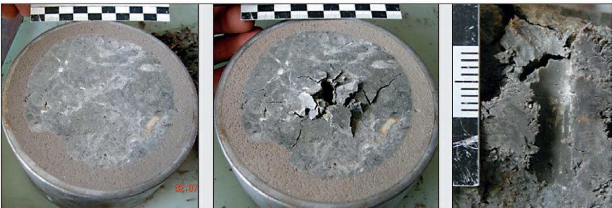
**Bild 5.13:** Beispiel Fotodokumentation Proctornadel-Versuch OSM(II)-BP4-2p: Versuchsoberfläche vor (links) und nach (mittig) Versuch, rechts: Detailaufnahme Querschnitt durch Versuchsstrecke
