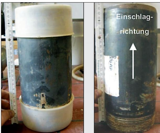
**Bild 4.7:** Entnahmezylinder aus Bohrungen (links: mit Plastik- kappe; rechts: nach Entfernen der Plastik- kappe)
