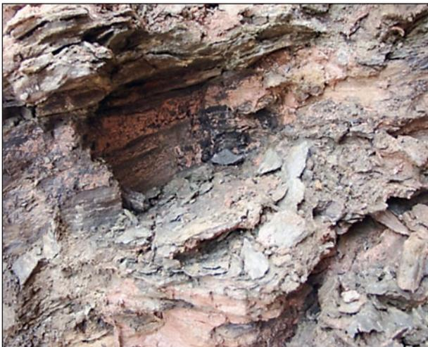
Bild 4.11: Detailausschnitt Entnahmestelle A.2: dunkelgrauer, plattiger Zechsteindolomit in Wechsellagerung mit verwitterten Tonsteinen des Bröckelschiefers (roter Ton, Konsistenz weich bis breiig)
