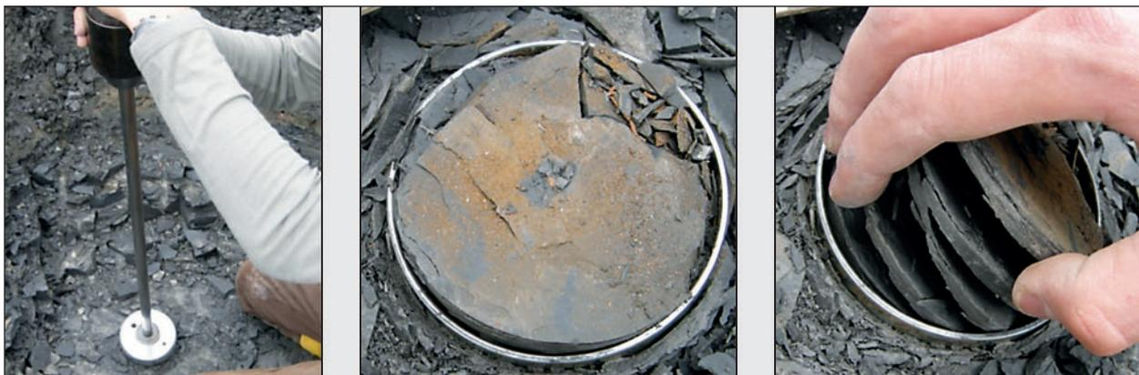
**Bild 4.5:** links: Einschlagen des Entnahmezylinders mittels Stange und Fallgewicht; mittig: eingeschlagener Entnahmezylinder (Anzahl Schläge für 12 cm Eindringtiefe >100 !); rechts: scheibenartig zerbrochene Probe
