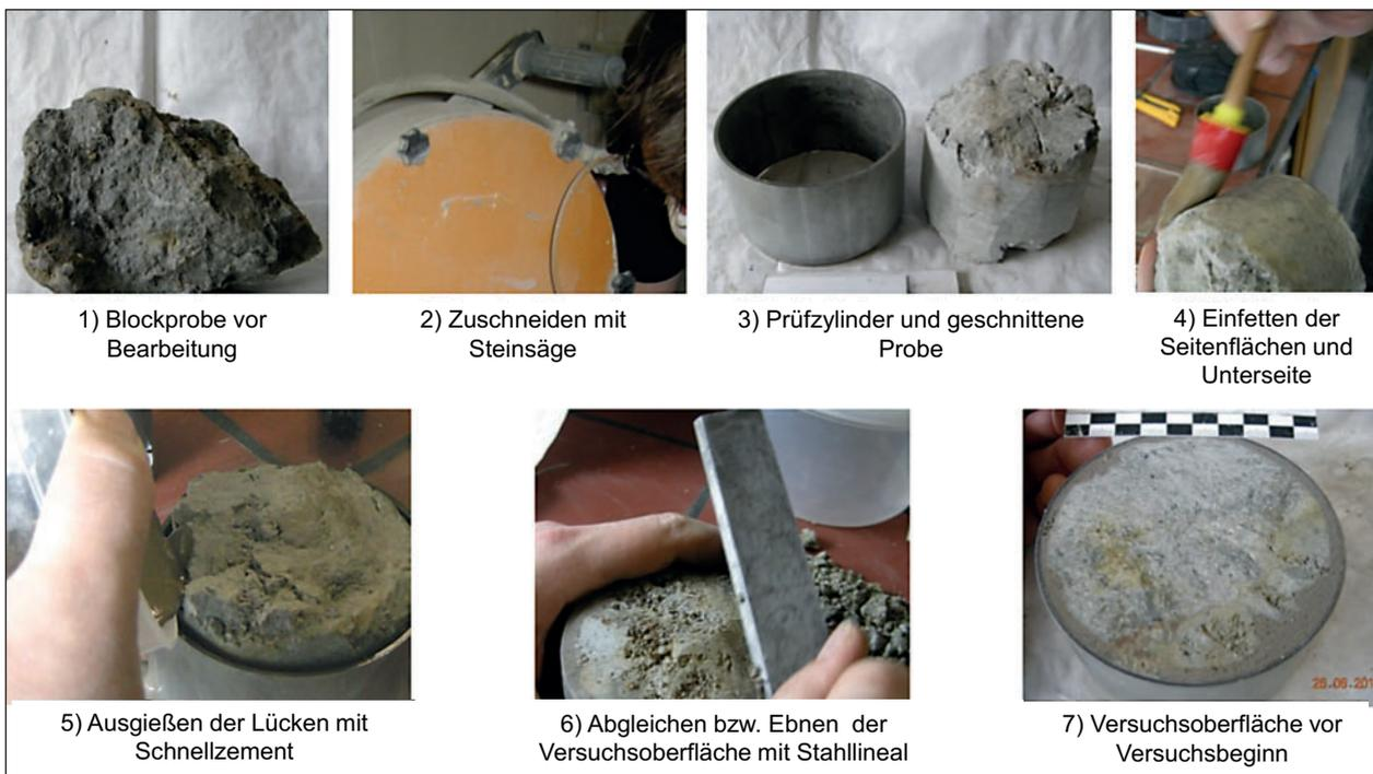
**Bild 5.5:** Herstellung Prüfkörper aus Blockprobe (analog für Kernprobe)
