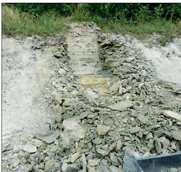
**Bild 4.16:** Entnahmestelle 2 (Mergelstein Mst(II)) nach Baggeraushub bis OK Kalksteinbank; Entnahme von Blockproben
