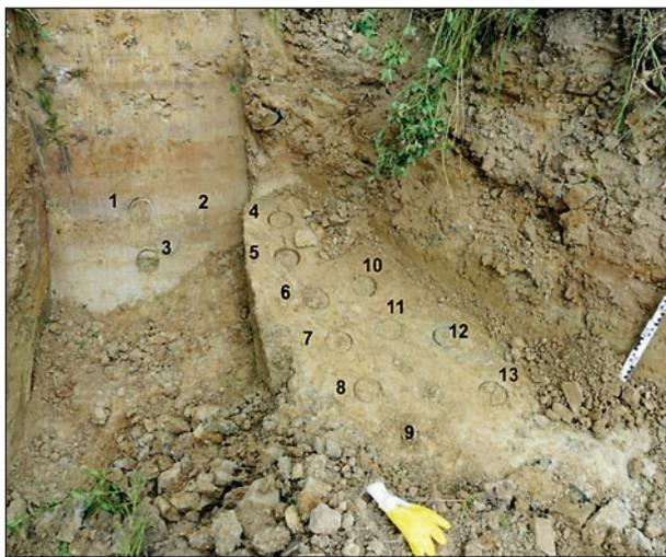
Bild 4.14: Mergel (A62 Höheinöd): Entnahmestelle 3 nach Einschlagen von 13 Entnahmemezylindern
