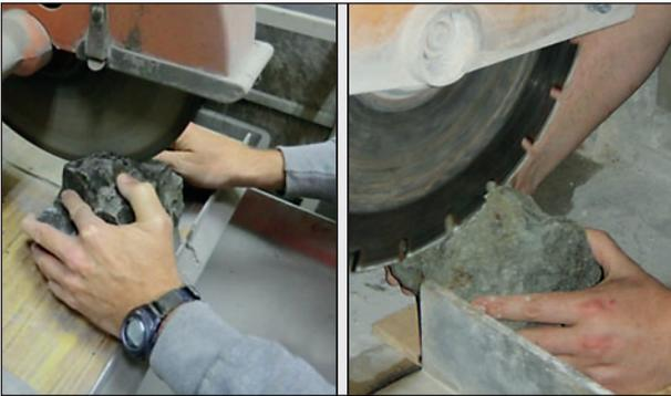
**Bild 5.1:** Zuschneiden eines Prüfkörpers für den einaxialen Druckversuch
