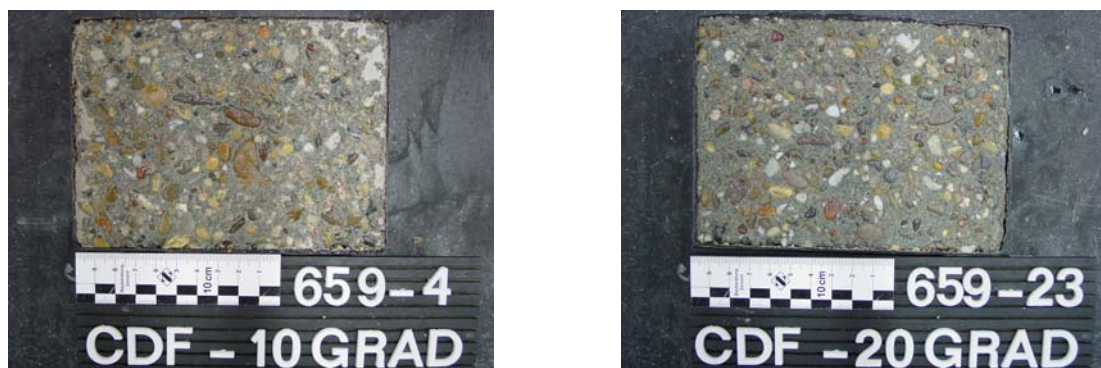
Abbildung 43: Vergleich der Prüffläche der Serie XI – CEM III/B, 0,50, 320 kg/m 3 nach 28 FTW mit 3% NaCl-Lösung bei a) -10°C und b) -20°C Minimaltemperatur
