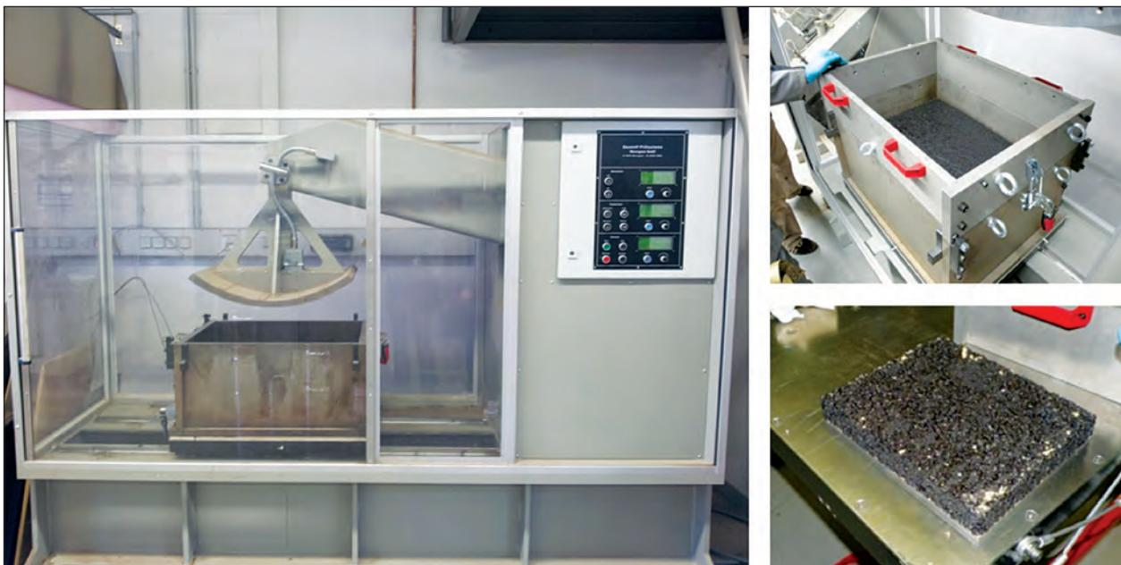
**Bild 10:** Walzsektor-Verdichtungsgerät zur Herstellung großformatiger Asphalt-Probplatten (500 x 700 x 300 mm<sup>3</sup>)
