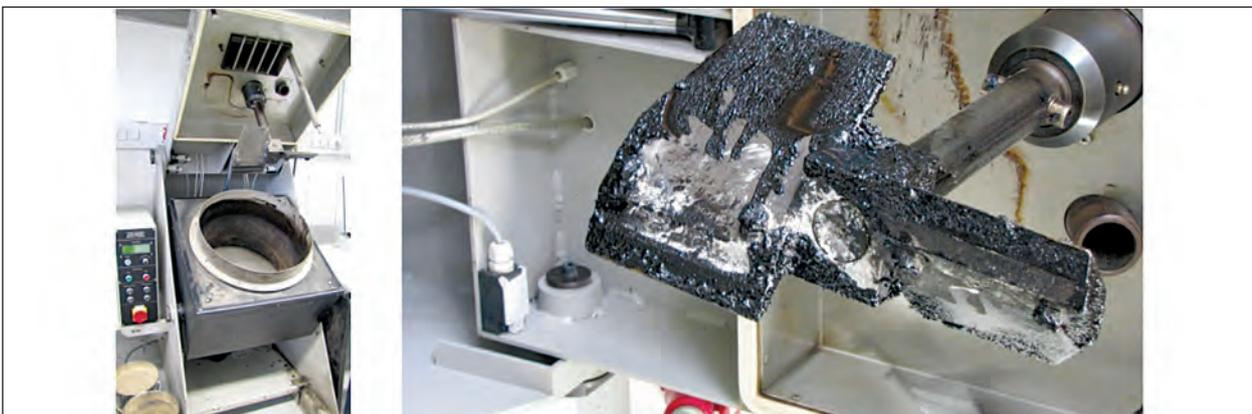
Bild 31: Labormischer mit Gegenlaufzwangsprinzip
