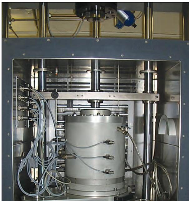
**Bild 22:** Prüfeinrichtung zur Durchführung eines Triaxialversuchs (Beispiel)
