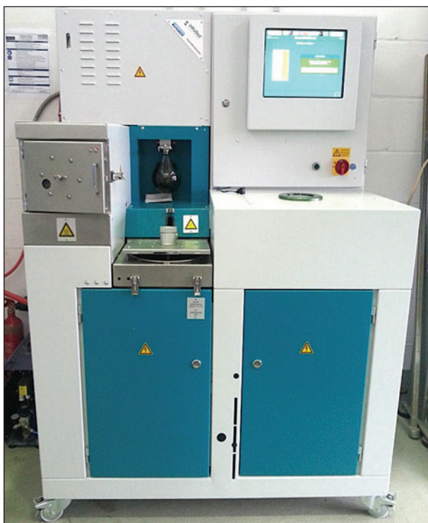
Bild 18: Anlage am ISBS für die automatische Extraktion mit OME als Lösemittel
