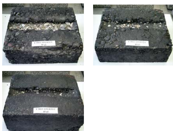
Abbildung 35: Spurrinne, ATS 0/32 C mit 3,5; 4,0; 4,5 M % Bindemittel im Mischgut
