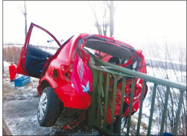
Bild 57: Pkw-Unfall an einem Geländerabschluss ohne Ausrundung (Foto: Freiwillige Feuerwehr Friedland/Sacher)
