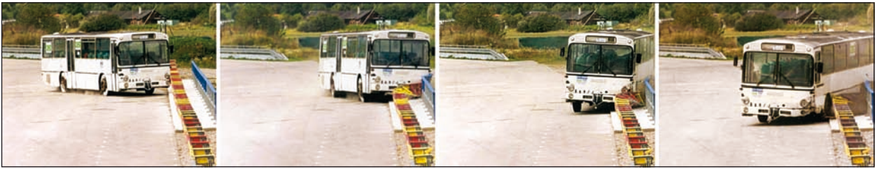
Bild 23: Umlenkung eines 13 t schweren Busses beim Anprall an eine auf der Messbrücke installierte Schutzeinrichtung, EDSP mit Geländer (BAST)
