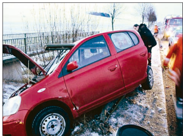
Bild 59: Pkw-Unfall an einem Geländerabschluss ohne Ausrundung (Foto: Freiwillige Feuerwehr Friedland/Sacher)
