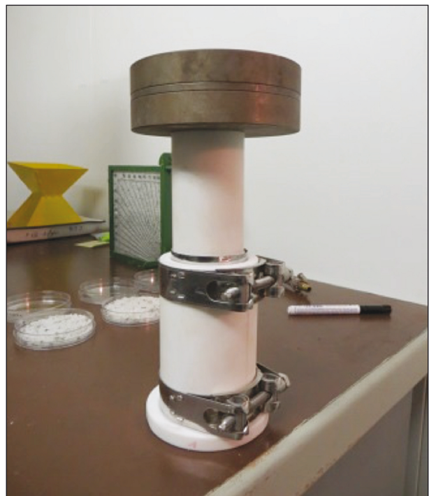
Bild 43: Drucktopf (in vertikaler Richtung belastet)
