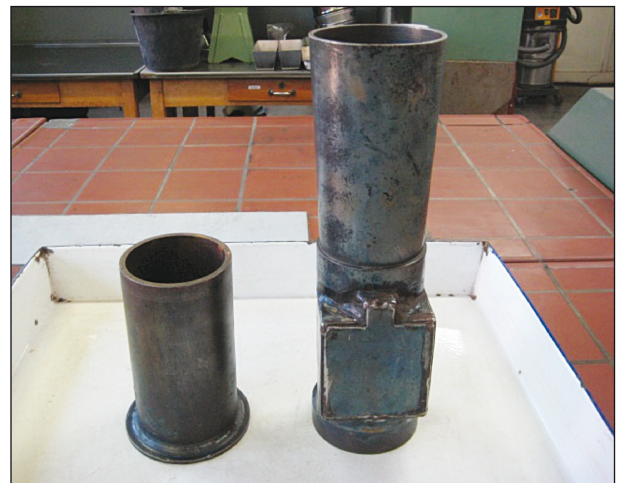
Bild 73: Gerät zur Bestimmung der Schüttdichte der UVR-FIA GmbH (links: 1 l Messgefäß; rechts Einfülltrichter mit Klappe)
