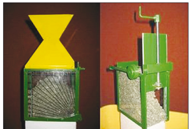
Bild 4: Links: Auslaufbox; rechts: Kombibox nach SONNTAG
