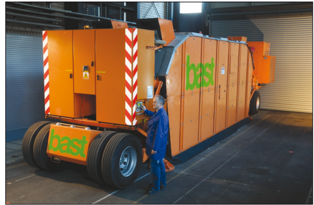
Bild 2-1: Mobile Load Simulator (MLS30) der BAST
