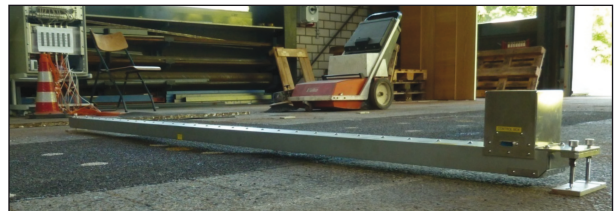
Bild 5-17: MLS P200 Profilometer auf Versuchsfeld 4
