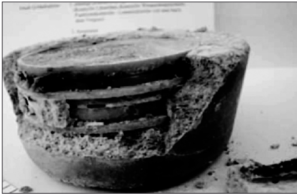
Bild 3: Probekörper mit Korrosionsdetektor (Quelle: Selsan Consult GmbH)
