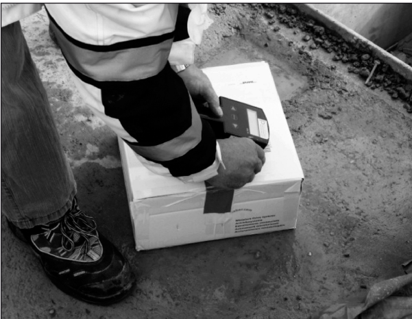
Bild 37: Messung am Detektor 7530671.1-3B-07-C mit dem Asphaltdecken-Simulationskörper
