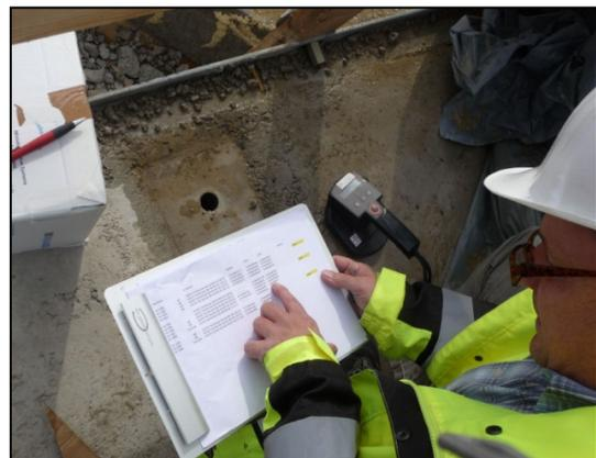
**Abb. 8:** Messung am Korrosionssensor 3B-06 und Feuchtesensor 1C-01
