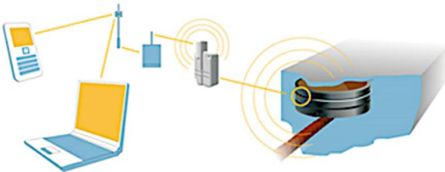
**Abb. 21:** Aktives RFID-Sensornetzwerk zur Fernabfragung (21)
