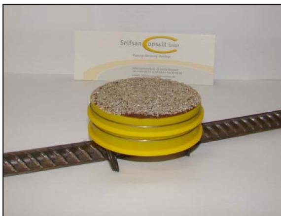
**Abb. 1:** Korrosionssensor Typ 3B mit 2 Sensordrähten
