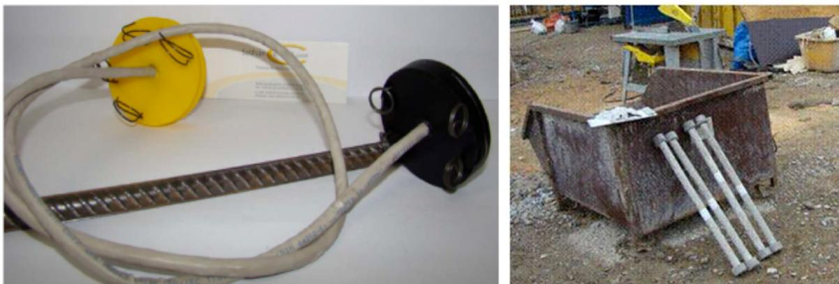
**Abb. 20:** Korrosionssensor – passiv, Einbaulänge 100cm, (li) flexibel, (re) steif (21)
