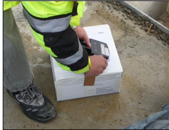
**Abb. 7:** Messung am Korrosionssensor 3B-06 und Feuchtesensor 1C-01 mit Asphaltdecken Simulationskörper
