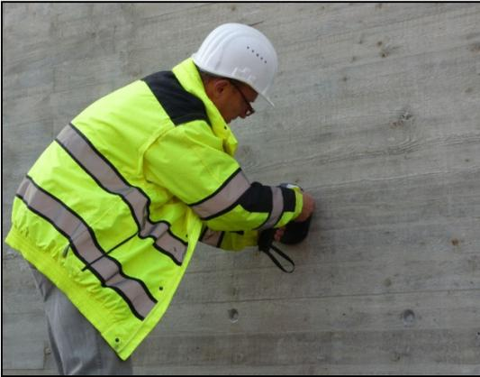
**Abb. 4:** Messung am Korrosionssensor 3B-02
