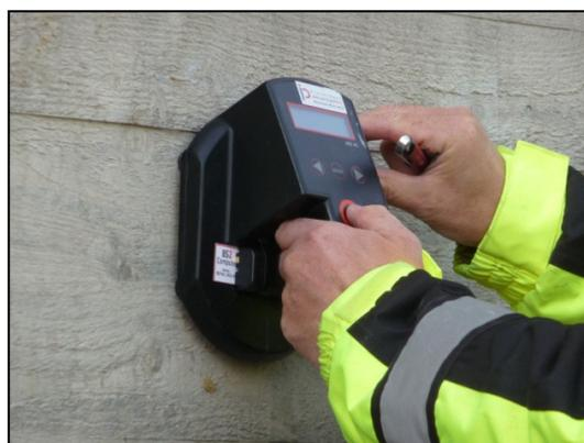
**Abb.3:** Messung am Korrosionssensor 3B-01
