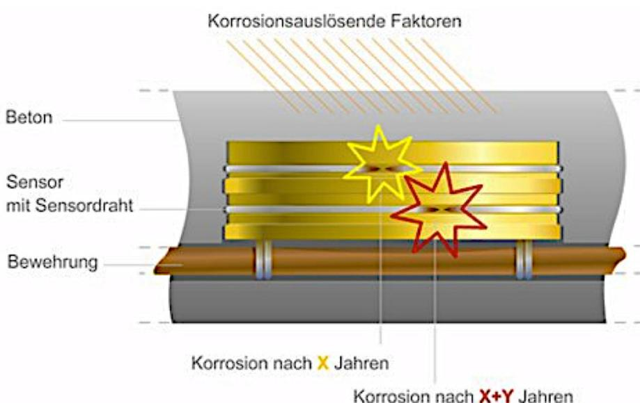
**Abb. 16:** Korrosionssensor (21)
