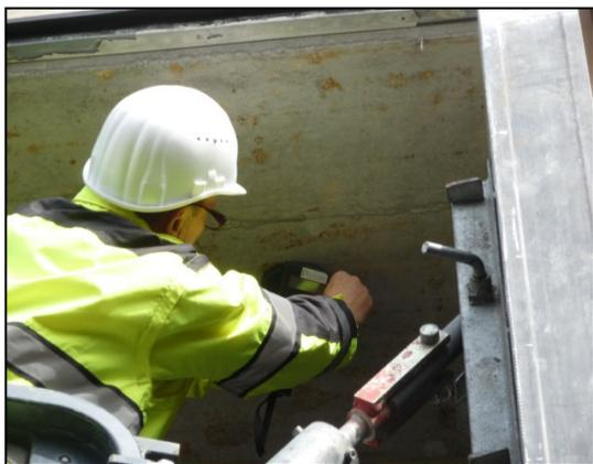
**Abb. 11:** Messung am Korrosionssensor 3B-04
