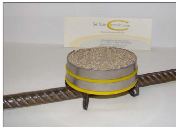
**Abb. 2:** Feuchtesensor Typ 1C mit Edelstahl-Sensorbändern (Quelle: Selsan Consult GmbH)
