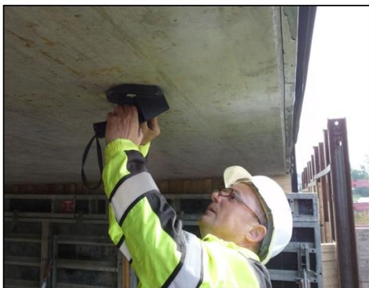
**Abb. 10:** Messung am Korrosionssensor 3B-05
