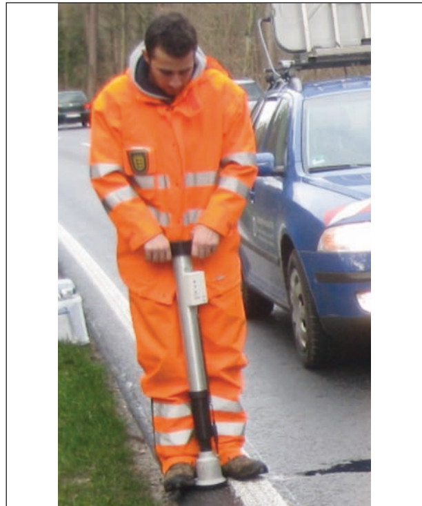
Bild 10: Einsatz des Salzmengensmessgerätes SOBO 20
