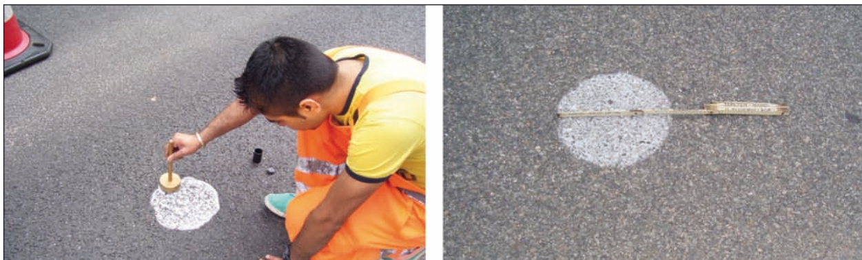
Bild 15: Durchführung des Sandfleckverfahrens
