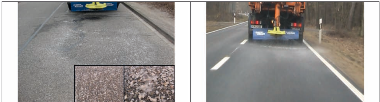
Bild 22: Streubild des frisch justierten Streuers im Stand (links) und bei der Hinterherfahrt (rechts)
