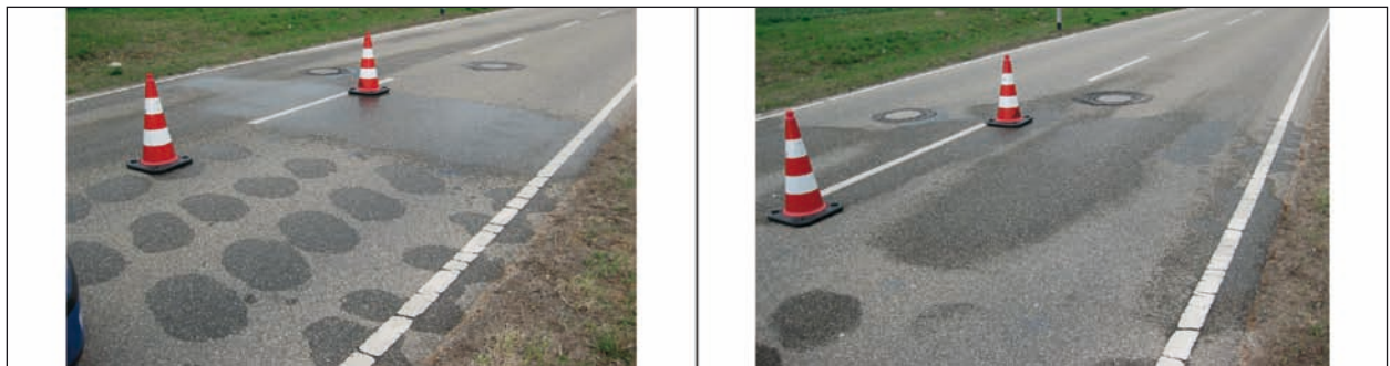
Bild 30: Messungen am Tag nach der Überfahrt (30.03.2012) mit dem Wasserschleppwagen auf trockener und erneut künstlich befeuchteter Fahrbahn um 09:30 Uhr (links) und um 10:30 (rechts)
