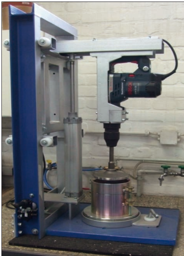
Bild 8: Vibrationshammer nach DIN EN 13286-4 [10] am FEHS-Institut
