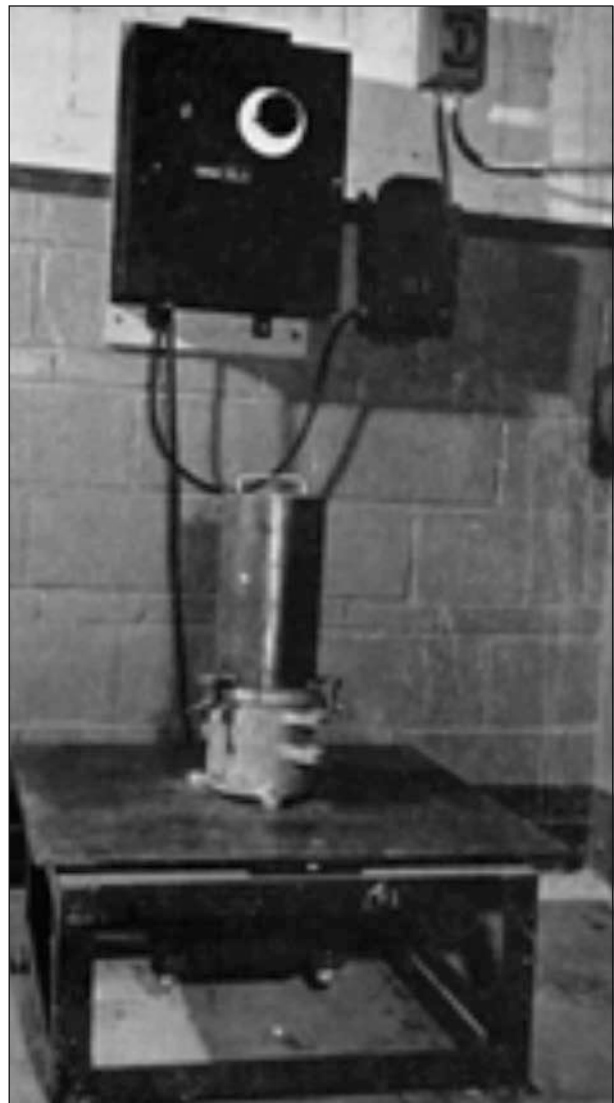
Bild 4: Vibrationstischversuchsstand nach PETTIBONE und HARDIN [23]
