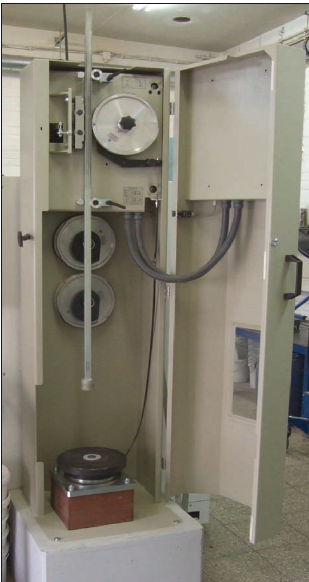
Fig. 2: Proctorverdenser nach DIN EN 13286-2
