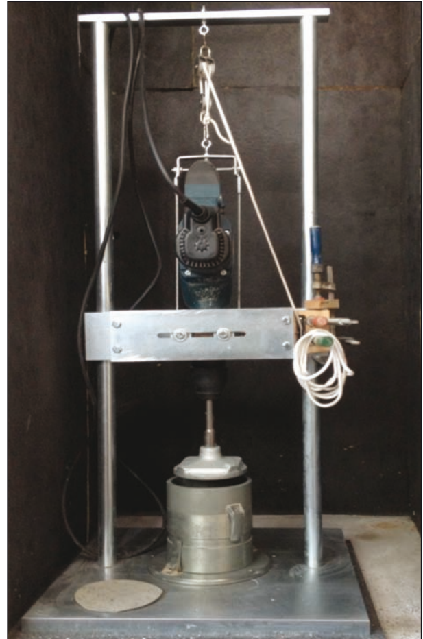
Bild 9: Vibrationshammer nach DIN EN 13286-4 [10] am IKM
