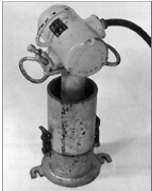
Bild 3: Schwedischer Vibrationshammer nach FORSSBLAD [17] aus PARSONS [21]
