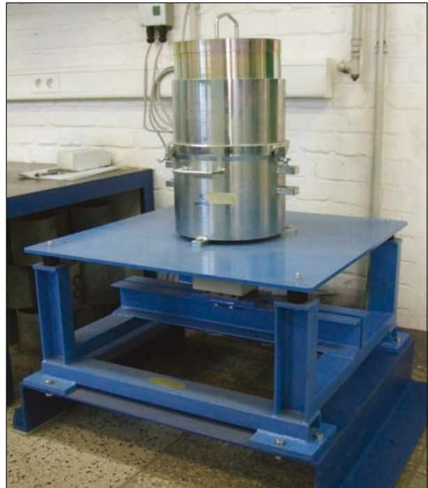
Bild 10: Vibrationstisch nach DIN EN 13286-5 [11] mit einem 280-mm-Ø-Probentopf am FEHS-Institut
