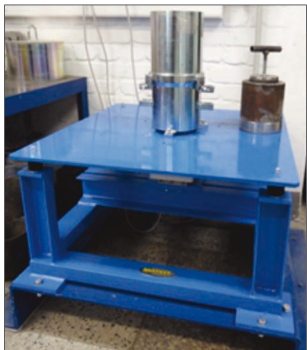
Bild 11: Vibrationstisch nach ASTM D4253 [1] mit einem 150-mm-Ø-Probentopf am FEHS-Institut
