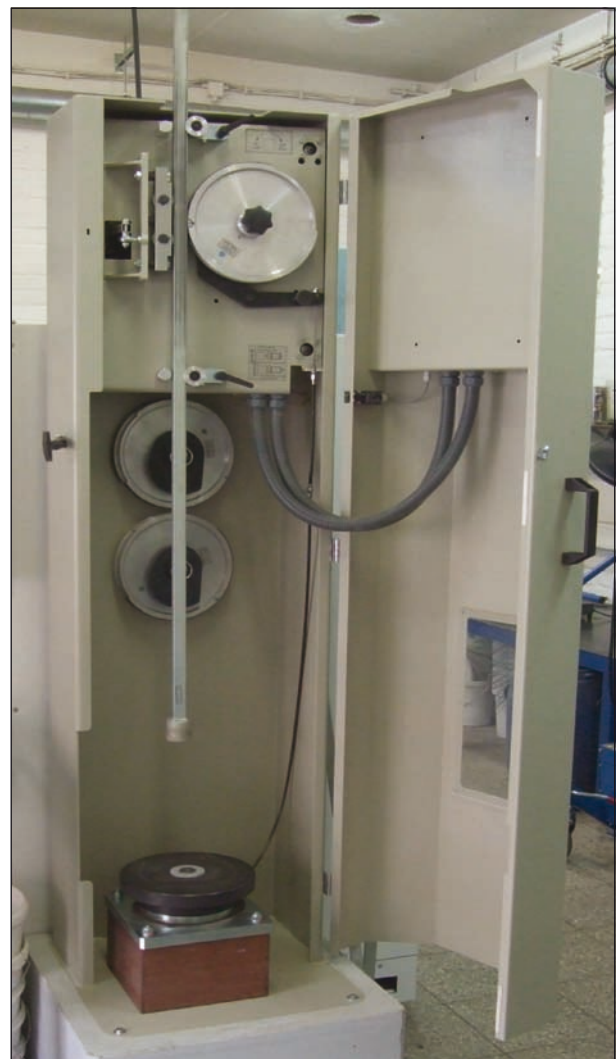
Bild 7: Proctorverdichter nach DIN EN 13286-2 [8]
